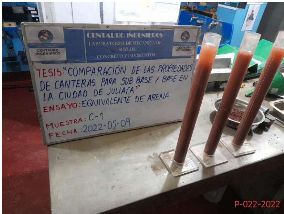
Fotografía 8. Ensayo de equivalente de arena de la cantera Taparachi
