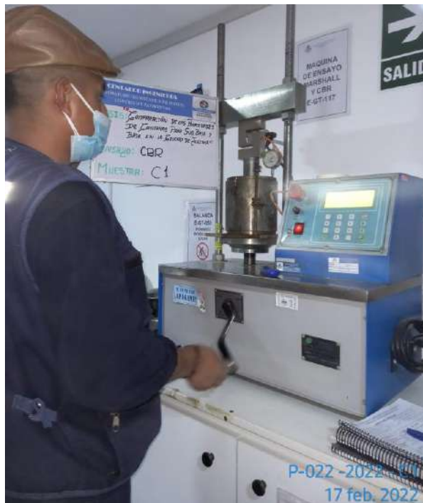
Fotografía 14. Prueba de CBR en el equipo de prueba digital
