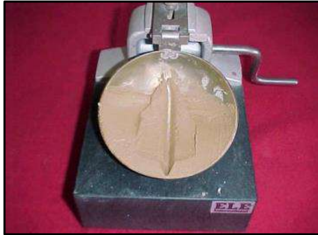
Figura 8. Determinación del Limite Liquido
