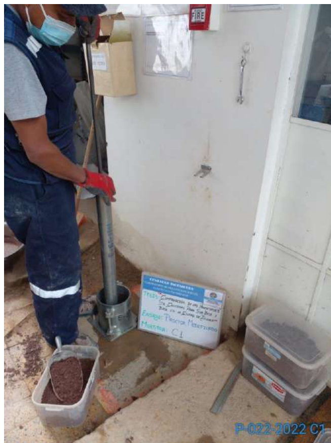
Fotografía 10. Ensayo de proctor modificado de la cantera Taparachi
