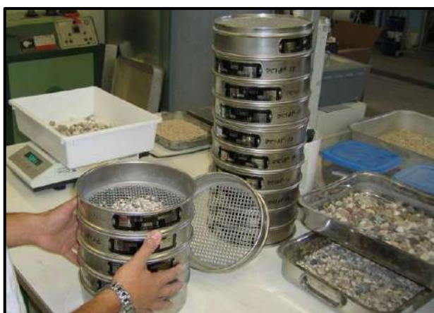
Figura 7. Ensayo granulométrico de los suelos
