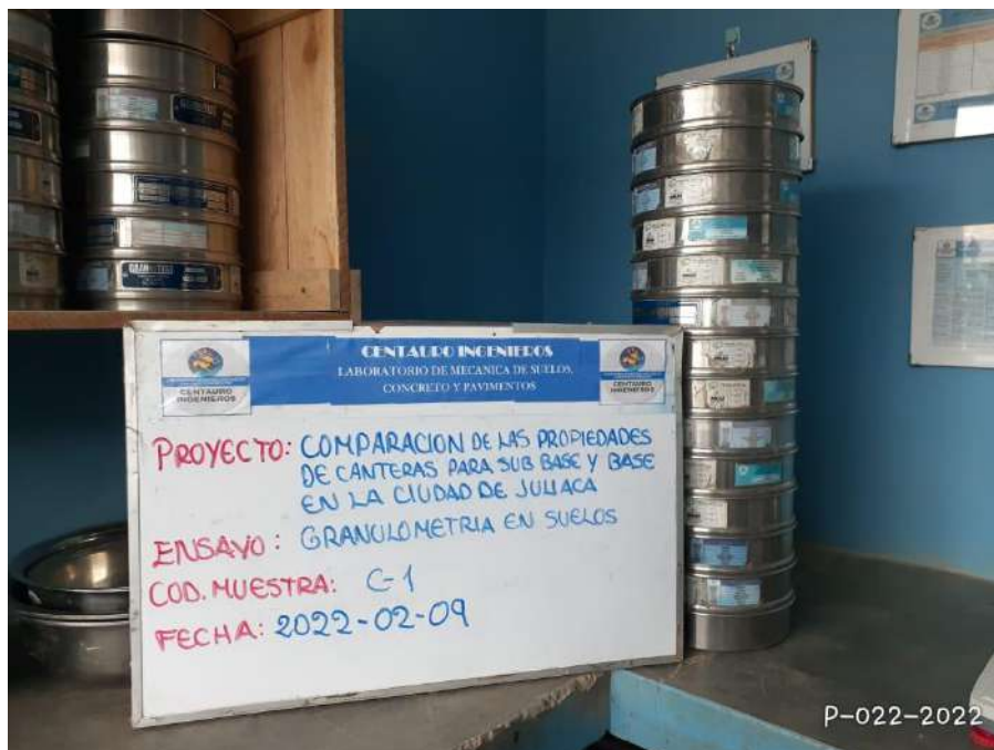
Fotografía 1. Ensayo de granulometría de cantera Taparachi
