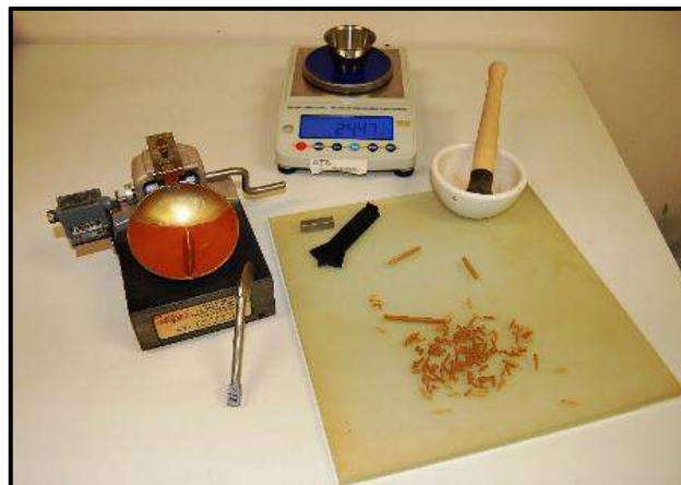
Figura 9. Determinación del límite plástico
