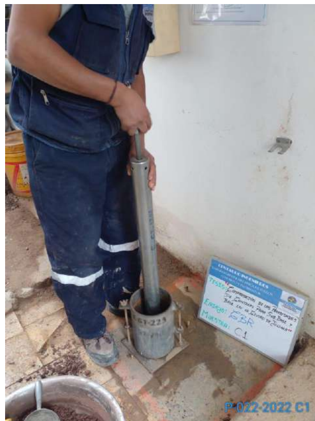
Fotografía 12. Ensayo de CBR de la cantera Taparachi
