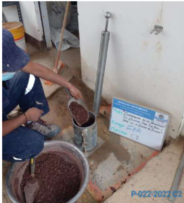
Fotografía 13. Ensayo de CBR de la cantera Mucra
