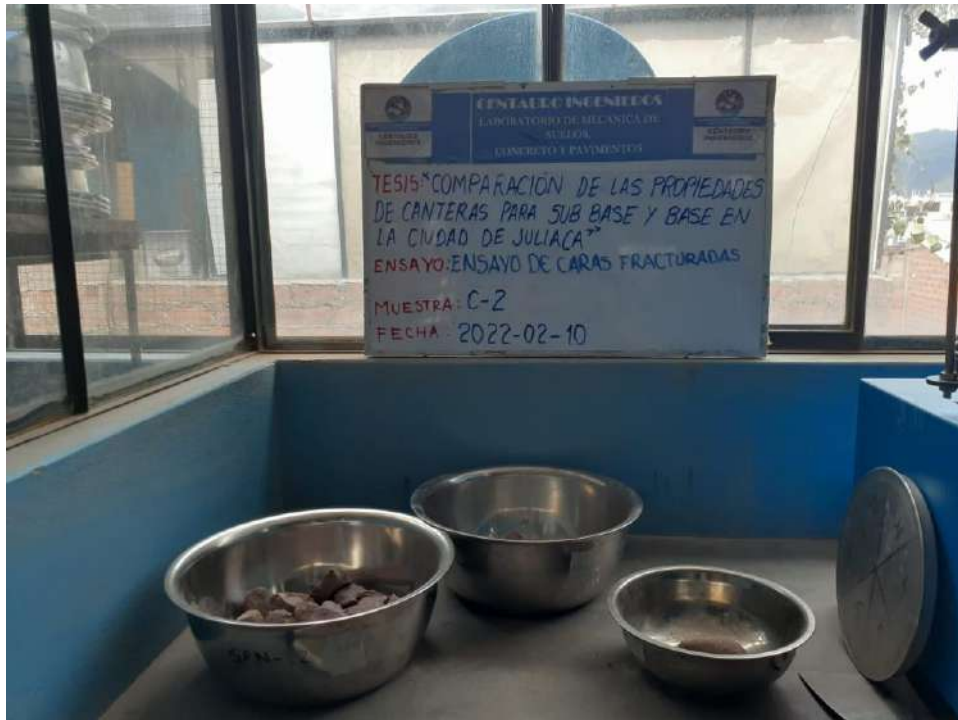
Fotografía 5. Ensayo de caras fracturadas de cantera Mucra
