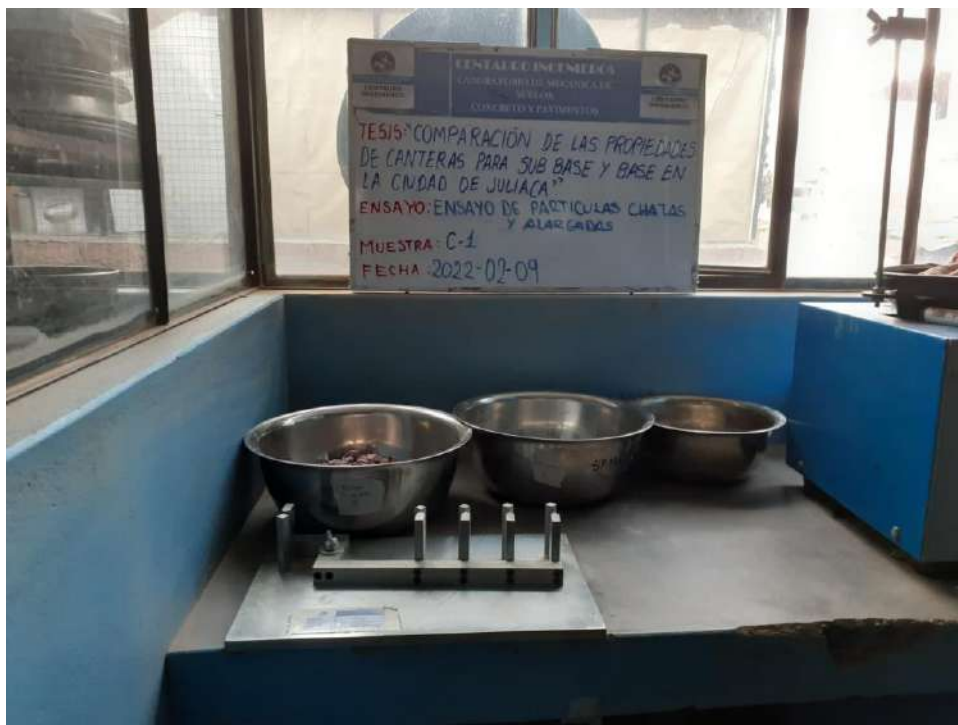
Fotografía 6. Ensayo de partículas chatas y alargadas de la cantera Taparachi
