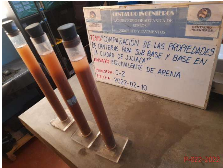
Fotografía 9. Ensayo de equivalente de arena de la cantera Mucra
