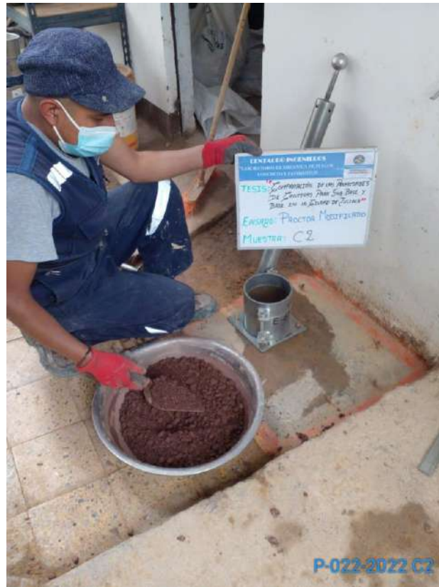
Fotografía 11. Ensayo de proctor modificado de la cantera Mucra
