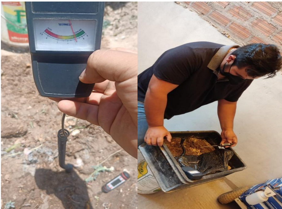
Figura 10. Lectura de pH y temperatura al final del compost
