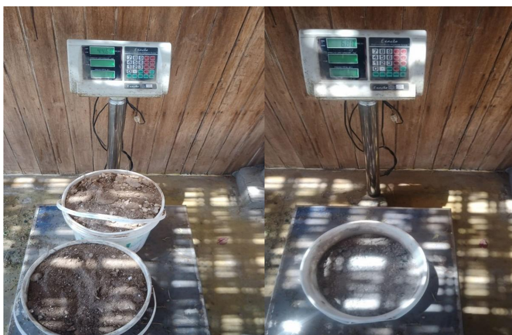
Figura 3. Toma de muestra y pesado de tierra agrícola y ceniza.
