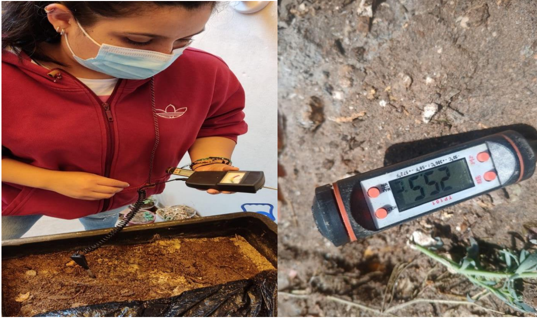
Figura 9. Lectura de pH y temperatura al inicio del compost
