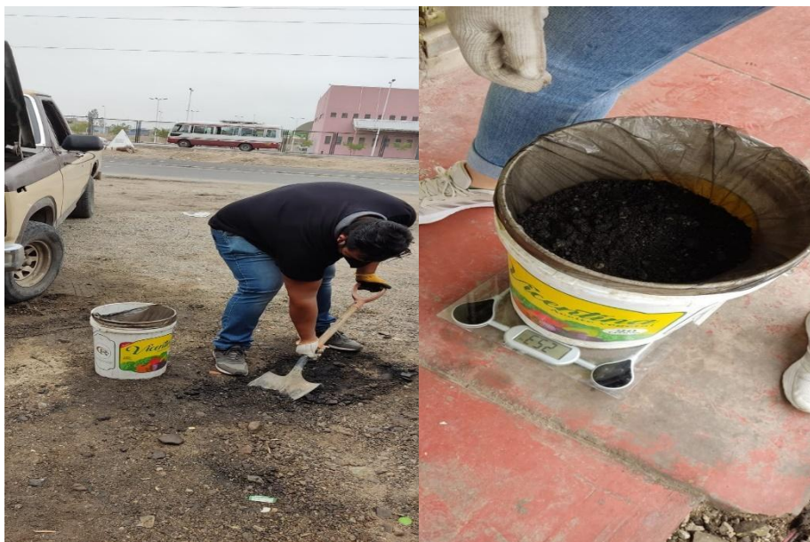
Figura 2. Toma de muestra de suelo contaminado con aceite automotriz
