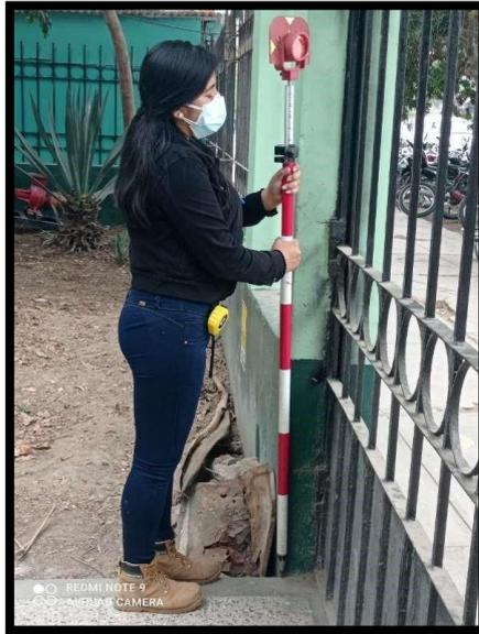
Fig.6: Levantamiento de vértice interno de muro perimétrico del complejo policial “Félix Tello Rojas” avenida Salaverry N° 929 - Chiclayo.
