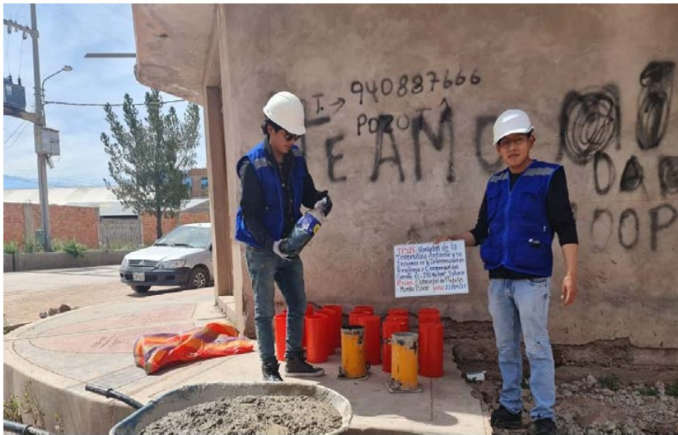
Fotografía 3. Elaboración de probetas - Muestra Patrón (P)
