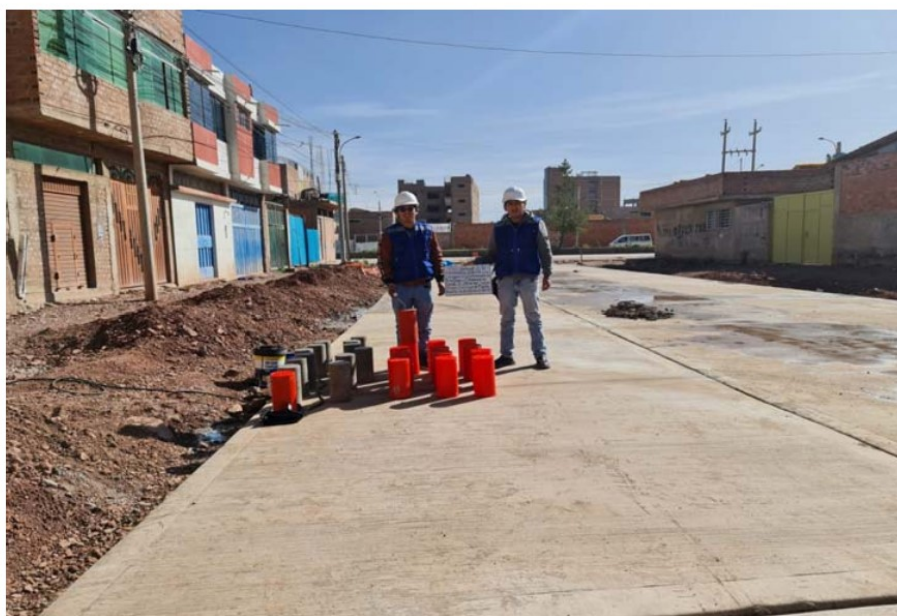
Fotografía 20. Desmolde de probetas - Muestra sumergida in situ (B)
