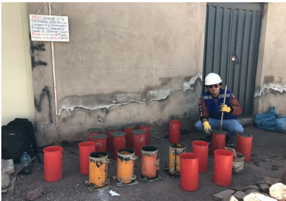
Fotografía 18. Elaboración de probetas - Muestra sumergida in situ (B)
