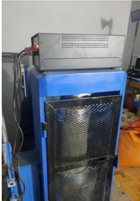
Fotografía 41. Ensayo de resistencia a compresión – Muestra In situ (B) Fuente: Elaboración propia.
