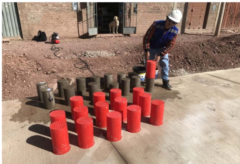
Fotografía14. Desmolde y curado de probetas - Muestra no sumergida in situ (A)
