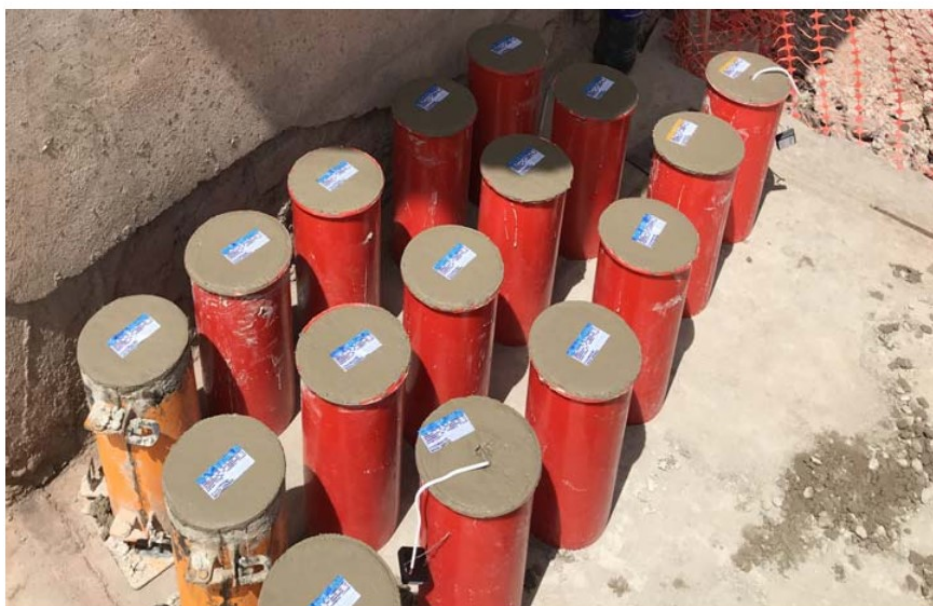
Fotografía 7. Elaboración de probetas - Muestra Patrón (P)
