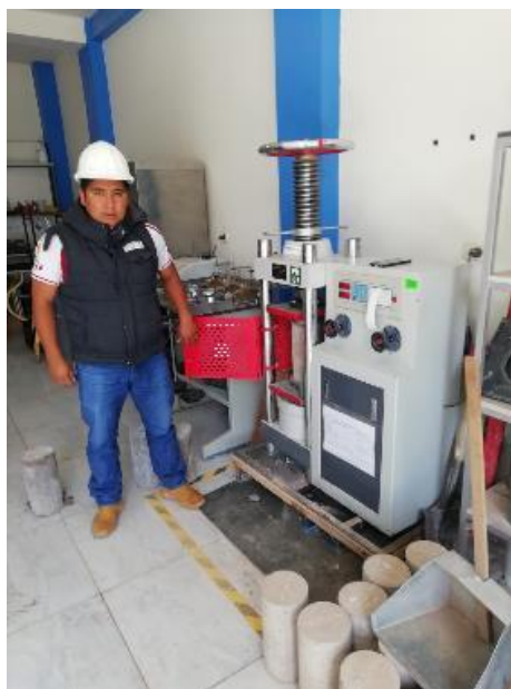
Figura 18: Ensayo de Compresión Axial
