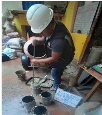
Figura 16: Ensayo del SLUMP
