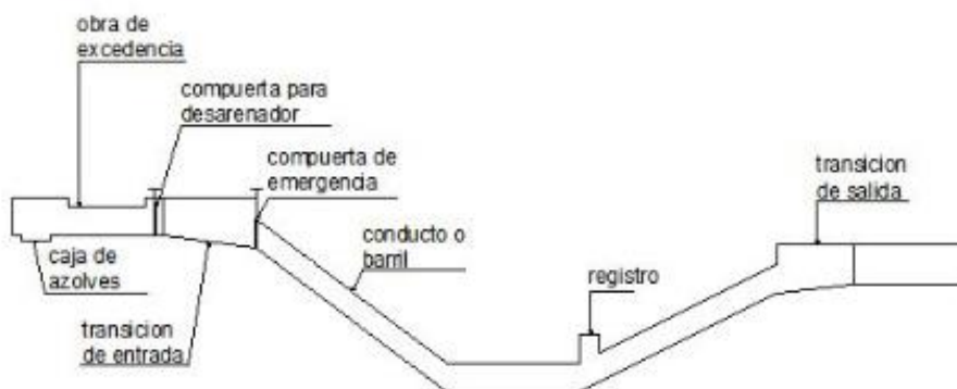
Figura 7 Partes de un Sifón Invertido Tomado de Villón Bejar, 2003.
