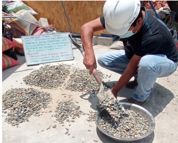
Figura 24. Cuarteo y selección del agregado grueso.
