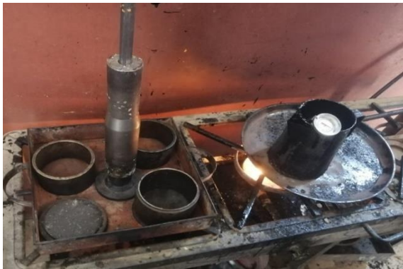
Figura 13. Calentado de los materiales a temperaturas de 135°C
