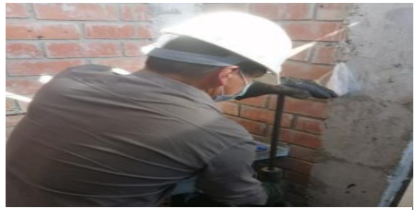
Figura 14. Compactación a 75 golpes por cara.
