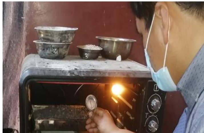
Figura 25. Secado del agregado grueso a una temperatura de 110°C - 24hr
