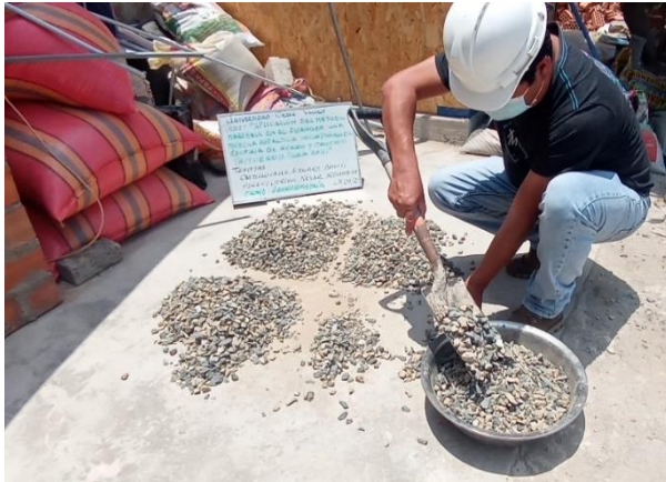
Figura 10. Cuarteo de agregado grueso
