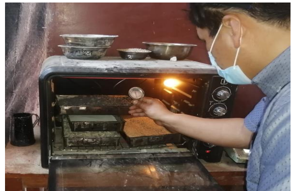
Figura 12. Calentado del Martillo Marshall y cemento asfáltico.
