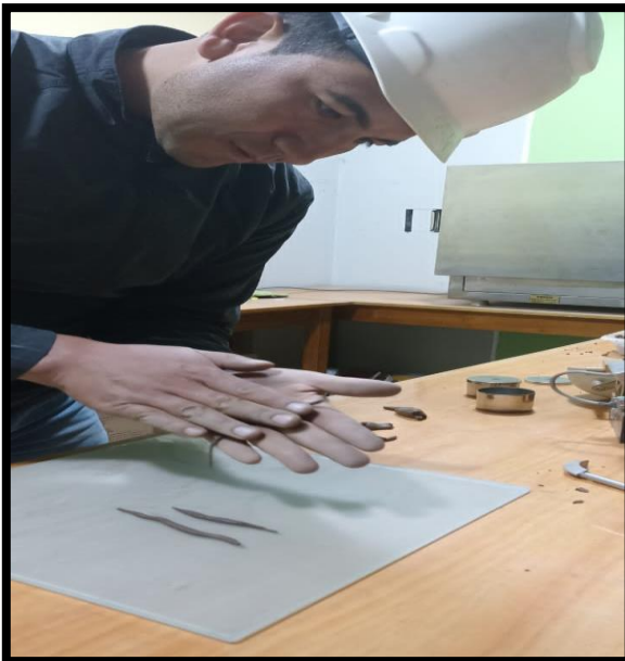
Figura 10: Ensayos de limite Plastico de las muestras.
