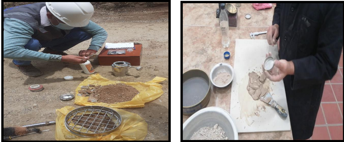
Figura 4. Caracterización del suelo del talud en estudio
