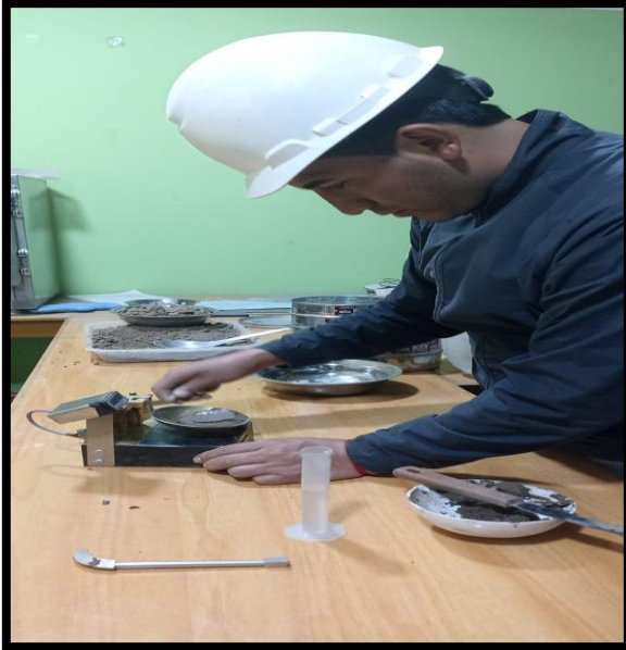
Figura 9: Ensayos de limite liquido de las muestras.
