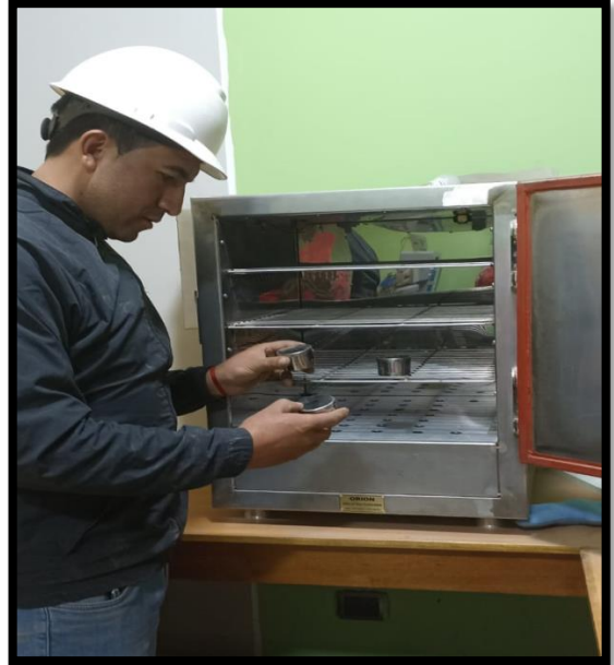
Figura 10: Ensayos de limite Plastico de las muestras.
