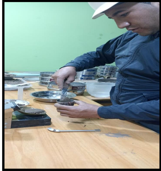
Figura 9: Ensayos de limite liquido de las muestras.
