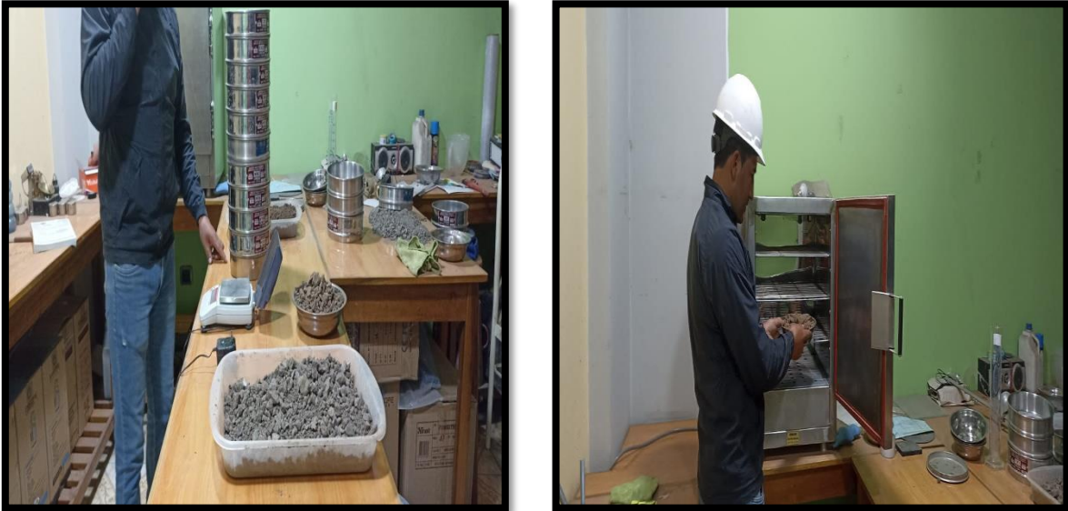
Figura 7: Determinación del contenido de humedad natural de las muestras.
