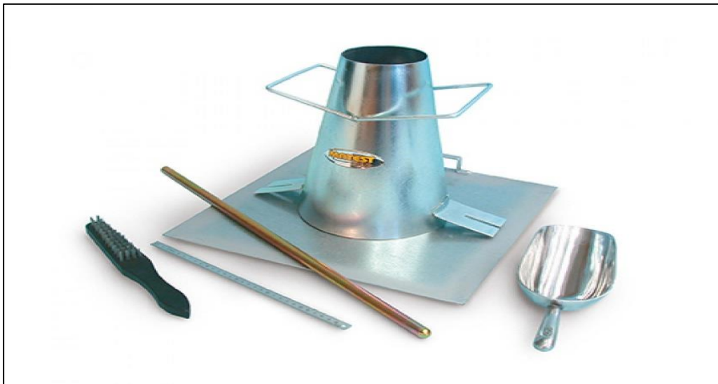
Figura 15. Instrumentos y equipos ensayo de asentamiento slump del concreto
