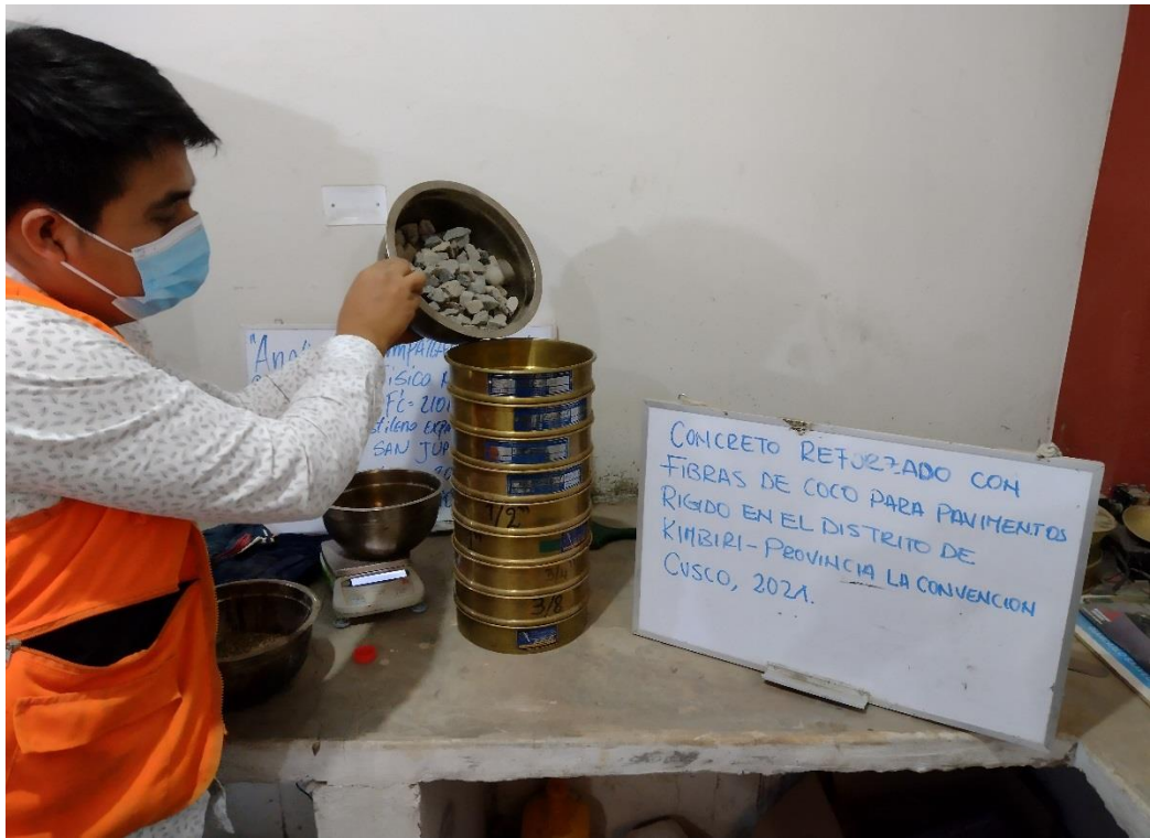
Figura 57. Ensayo granulométrico de agregados gruesos
