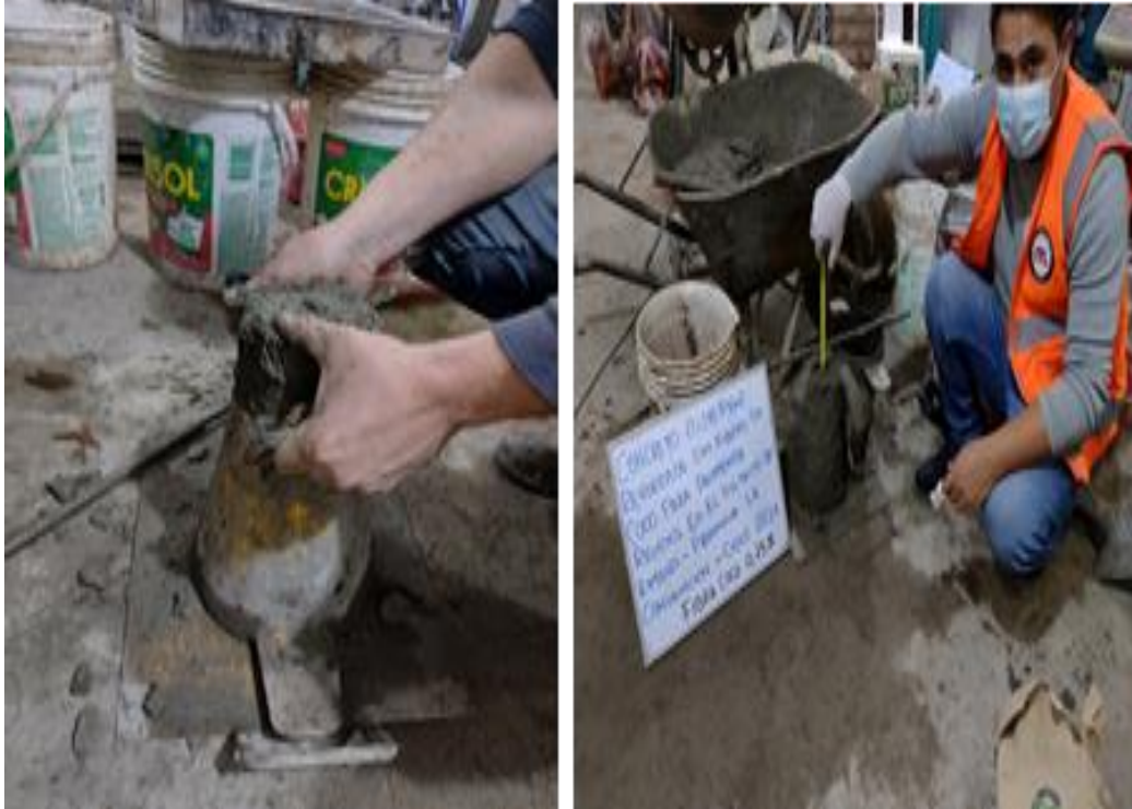
Figura 66. Ensayo de asentamiento (slump) de concreto fresco
