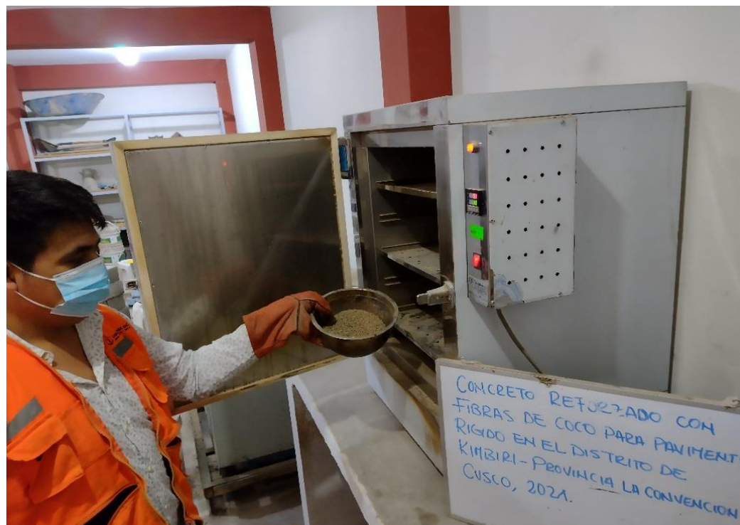
Figura 61. Colocación de la muestra en la estufa para determinar la densidad relativa (peso específico y absorción)
