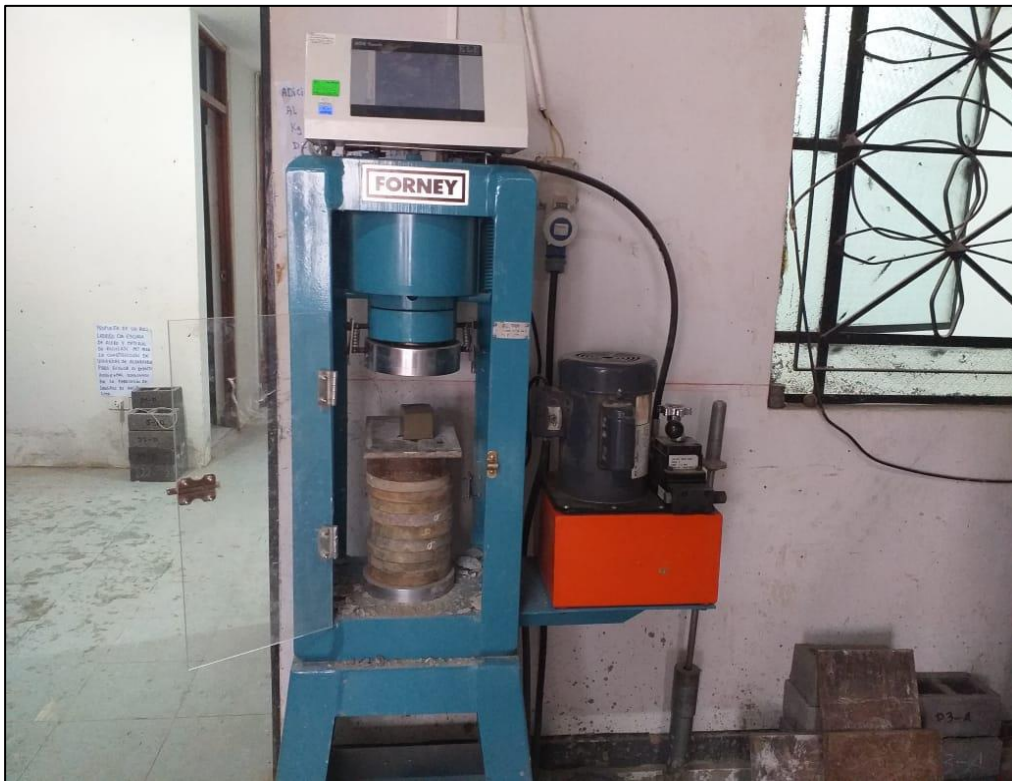
Figura 17. Instrumentos y equipos para la resistencia a la compresión
