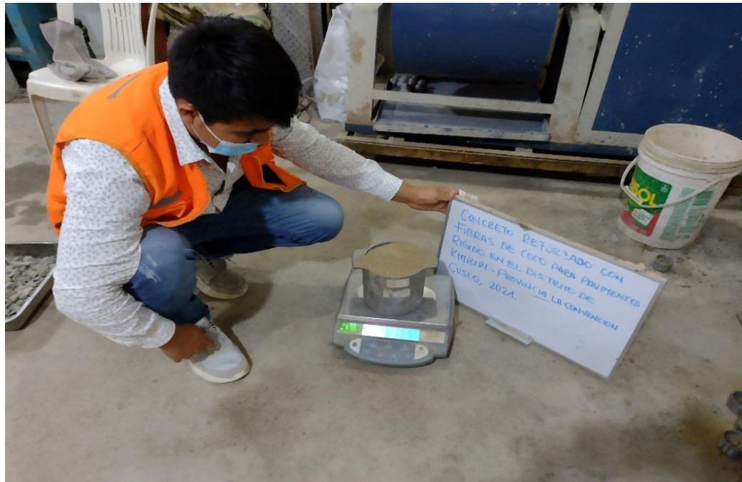
Figura 60. Pesado del agregado suelto compactado
