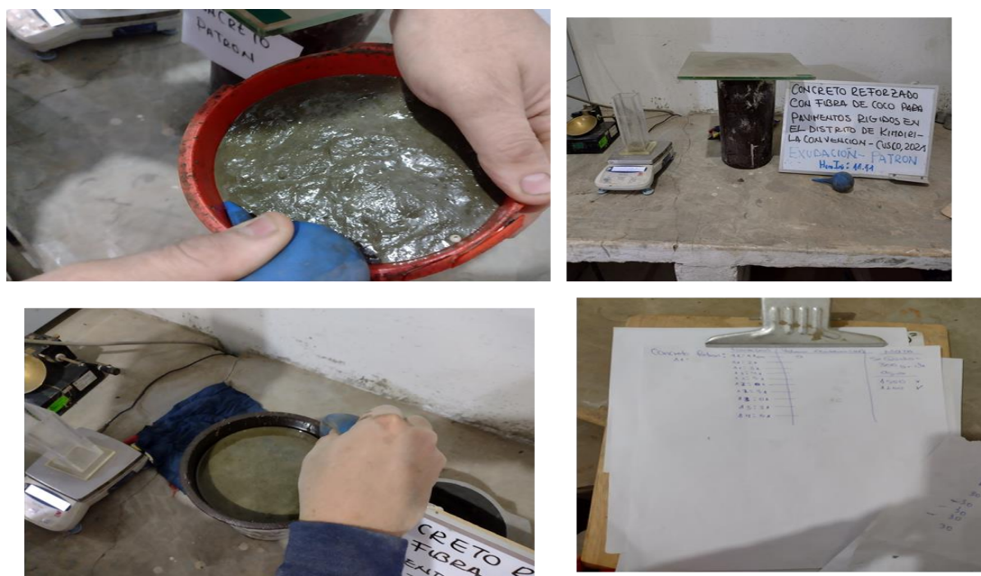
Figura 79. Toma de registro del pesado del agua exudada del concreto según el control de tiempo
