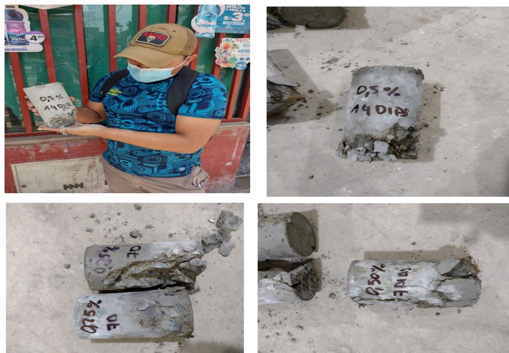
Figura 73. Fallas en las probetas cilíndricas
