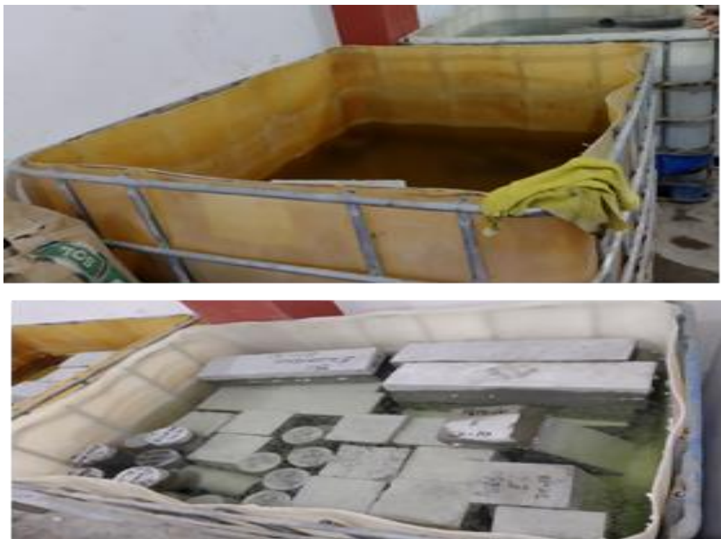
Figura 69. Curado de las muestras cilíndricas y tipo viga
