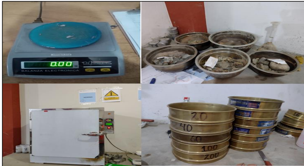
Figura 12. Instrumentos y equipos para el Análisis Granulométrico
