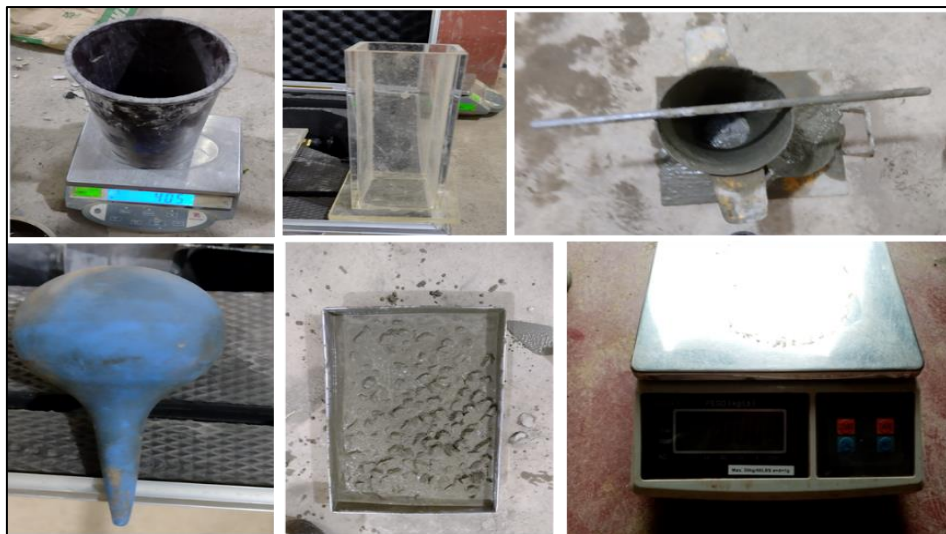
Figura 4. Instrumentos para el ensayo de exudación
