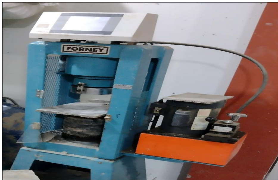
Figura 5. Prensa digital para rotura de cilindros de concreto
