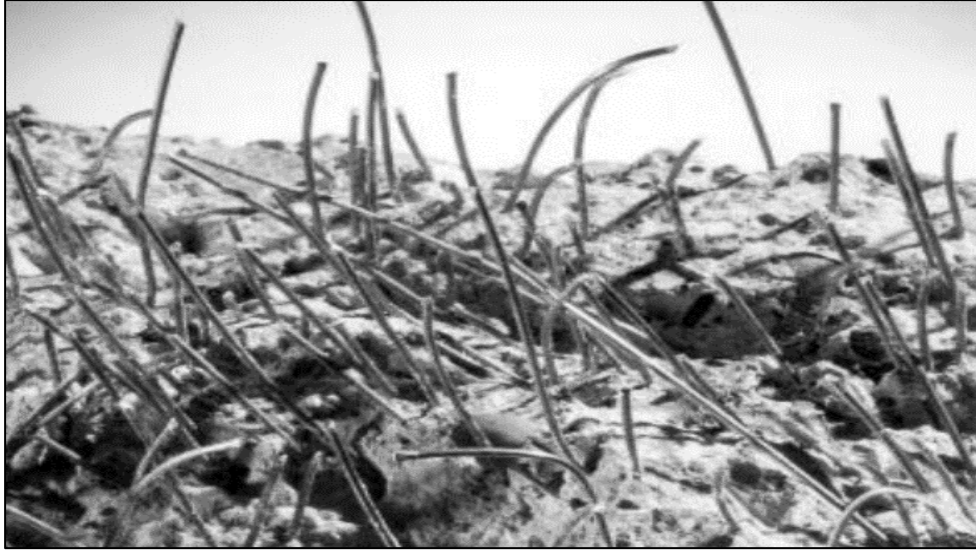
Figura 10. Distribución de fibras naturales en concreto
