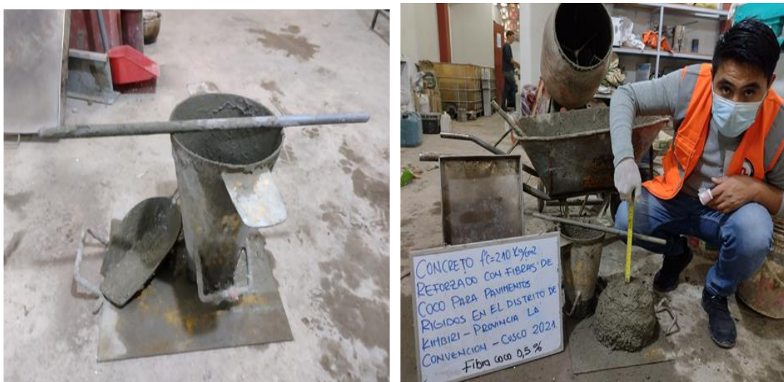
Figura 32. Determinación del asentamiento “slump” del concreto en laboratorio
