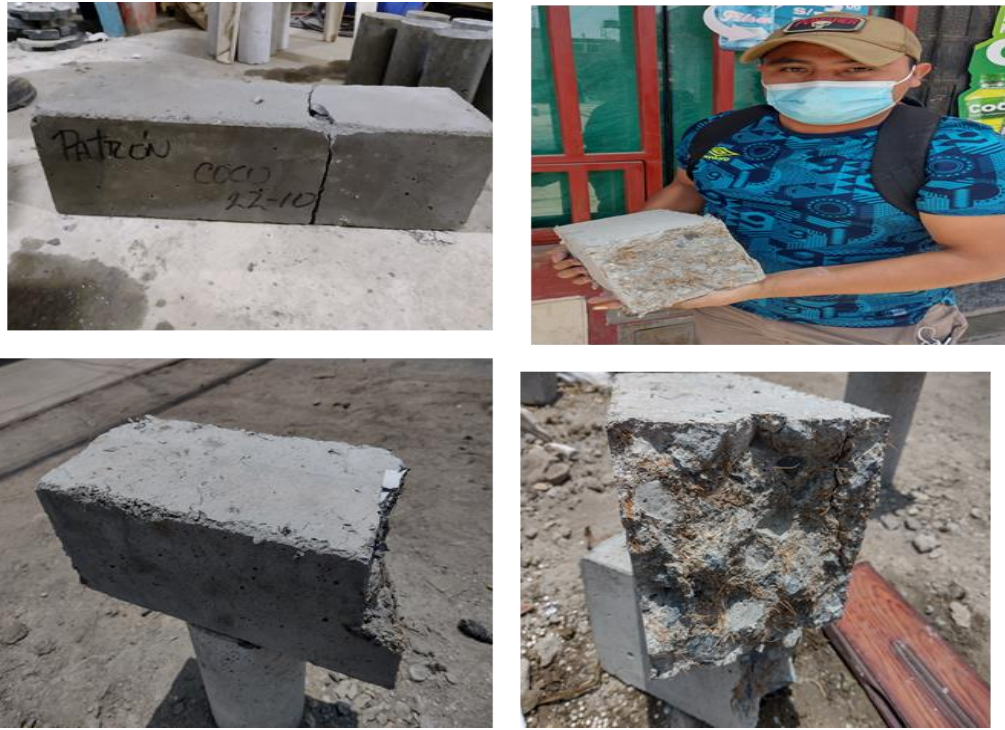
Figura 74. Fallas en las muestras tipo viga y muestra de distribución de la fibra en el concreto
