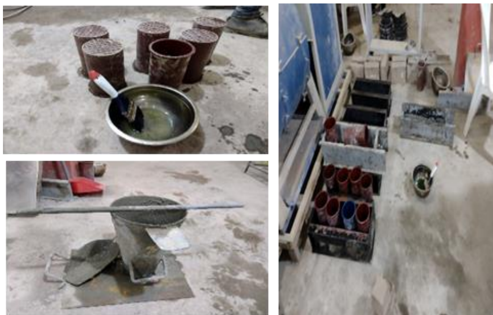
Figura 65. Instrumentos para ensayo de asentamiento y moldes para probetas cilíndricas y tipo viga
