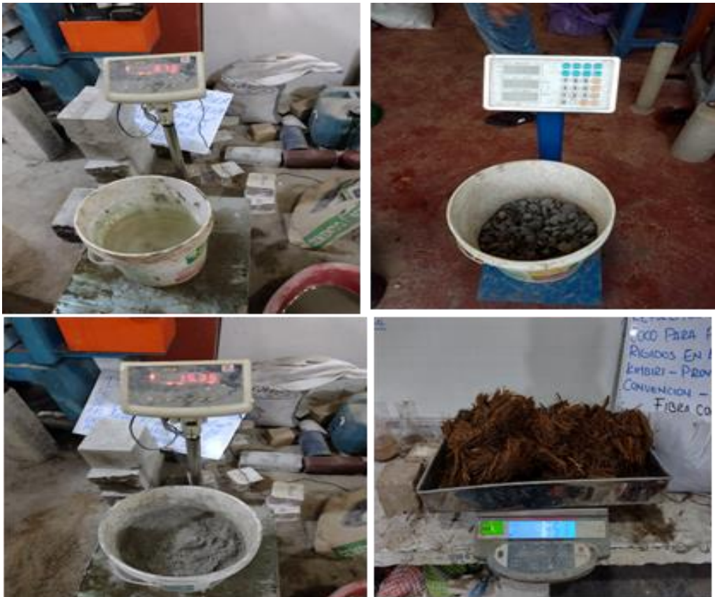
Figura 63. Pesado de los agregados, cemento, agua y fibra de coco
