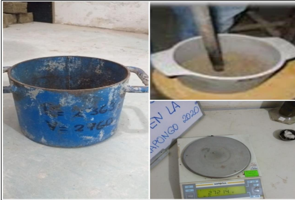
Figura 13. Instrumentos y equipos para el Peso Unitario.
