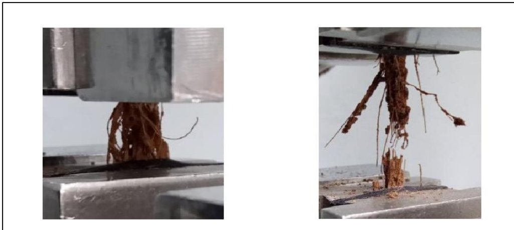
Figura 29. Ensayo de resistencia a tracción de la fibra de coco
