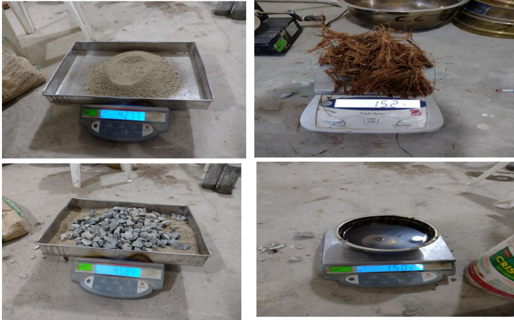
Figura 76. Pesado de los componentes del concreto y fibra de coco para determinar el ensayo de exudación
