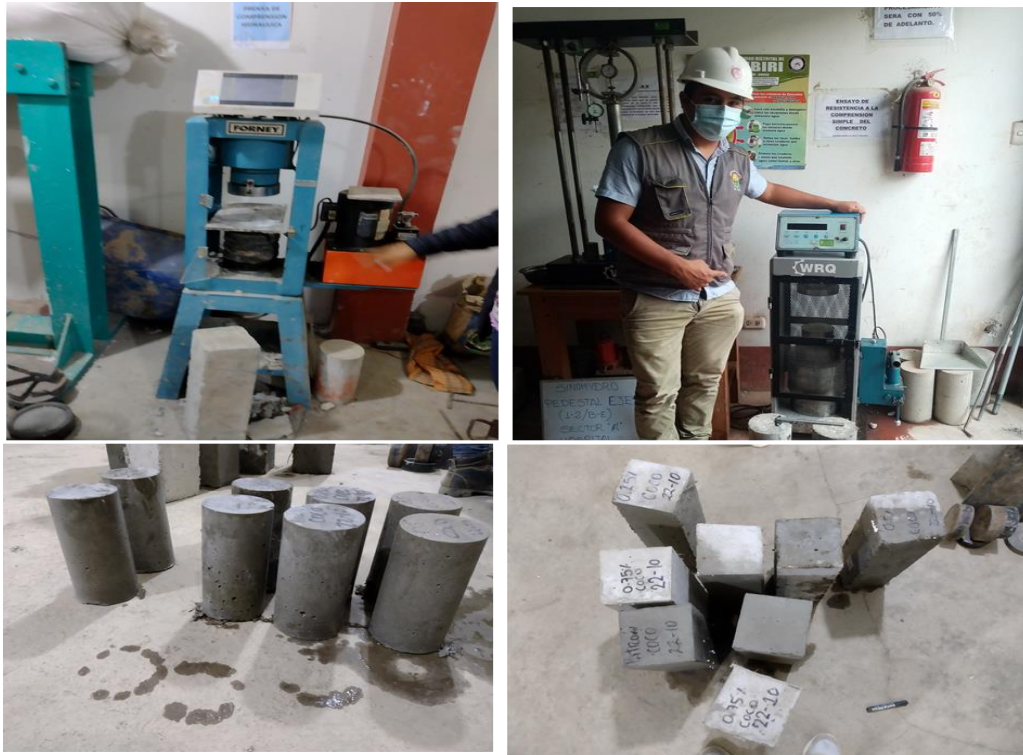
Figura 70. Equipo para ensayo a compresión y flexión, muestras tipo cilíndricas y tipo vigas debidamente curadas a 7, 14 y 28 días
