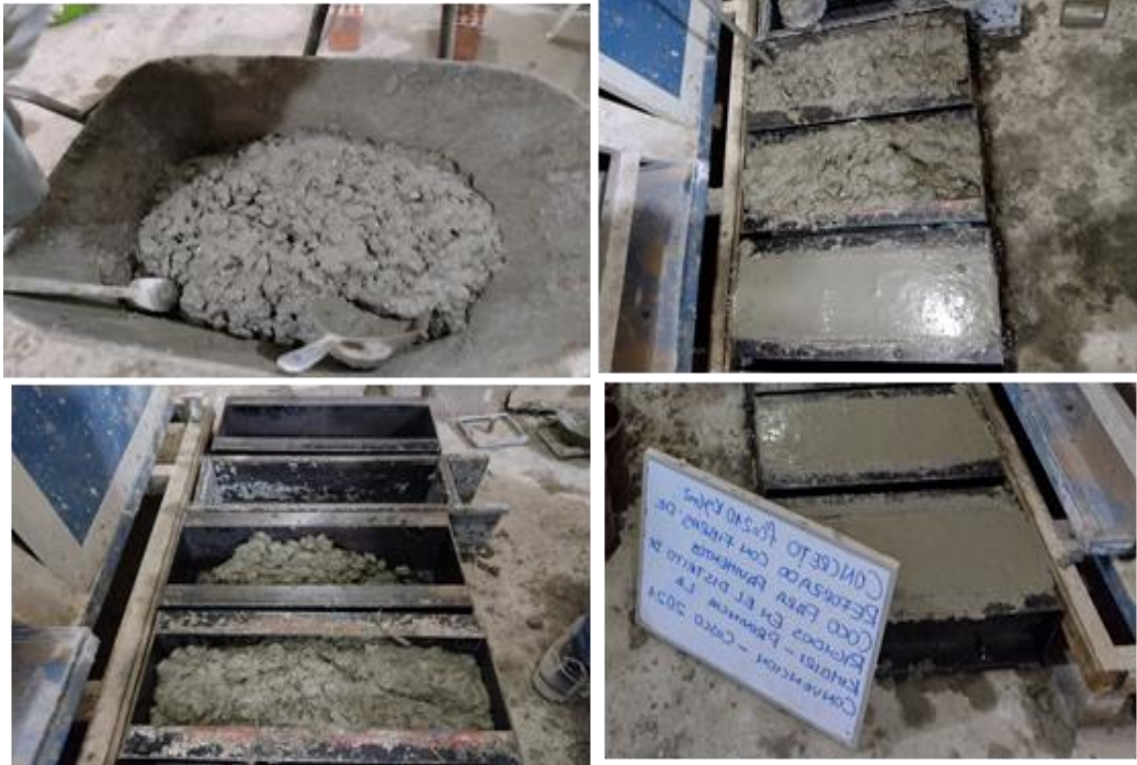
Figura 68. Muestreo de moldes tipo viga
