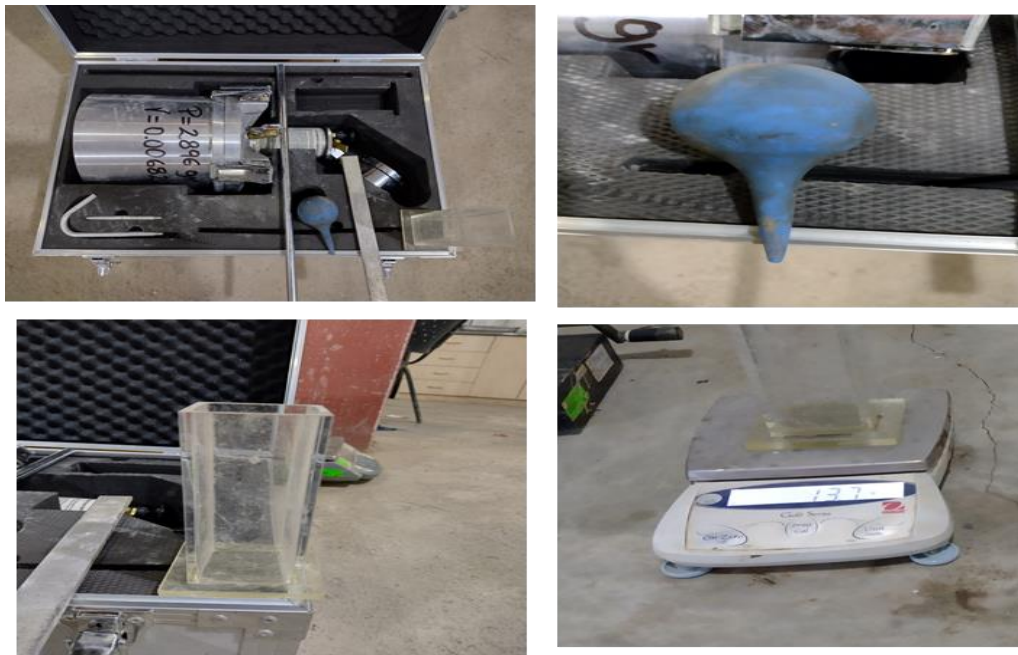
Figura 75. Instrumentos para la realización del ensayo de exudación de concretos frescos
