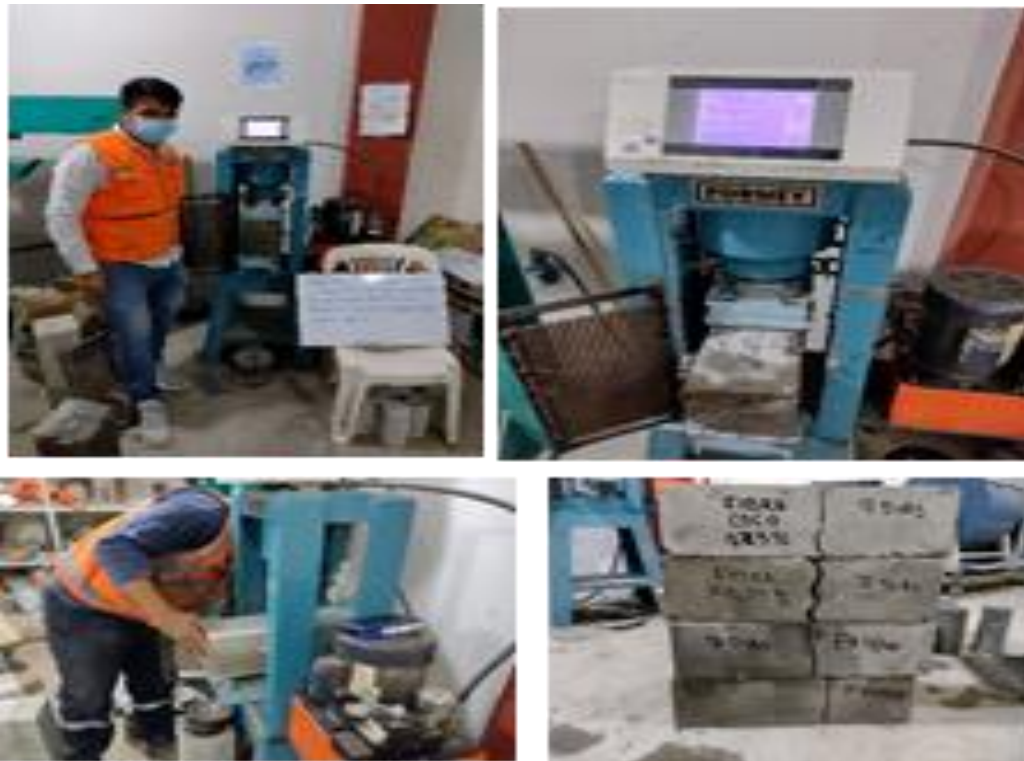
Figura 72. Ensayo de resistencia a flexión de muestras tipo viga
