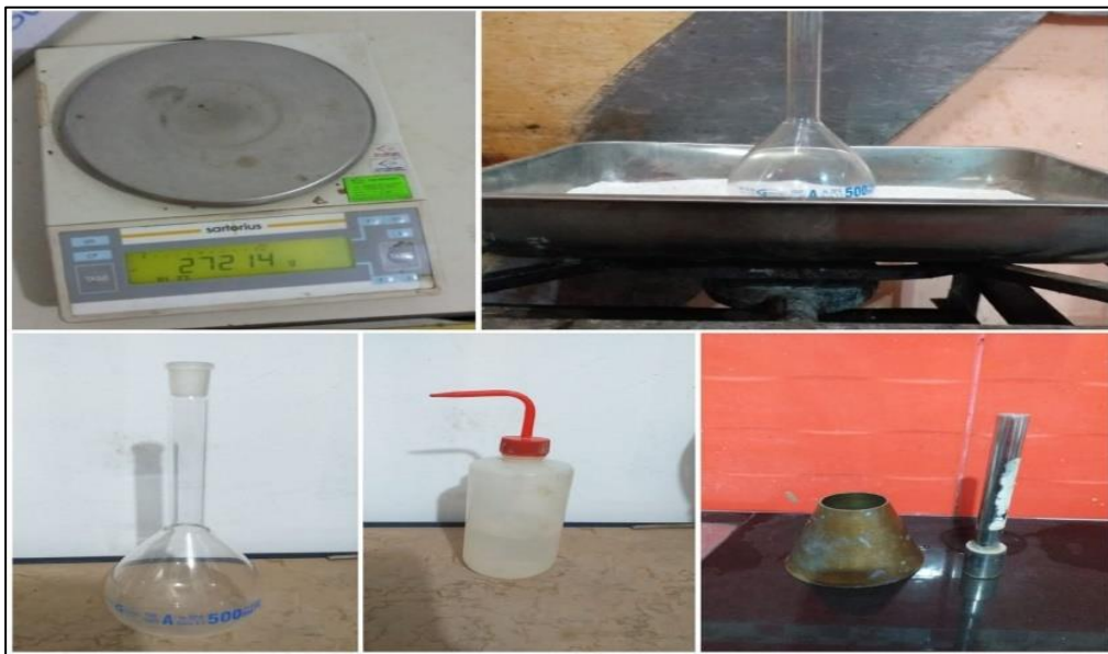
Figura 14. Instrumentos y equipos para el Peso Específico
