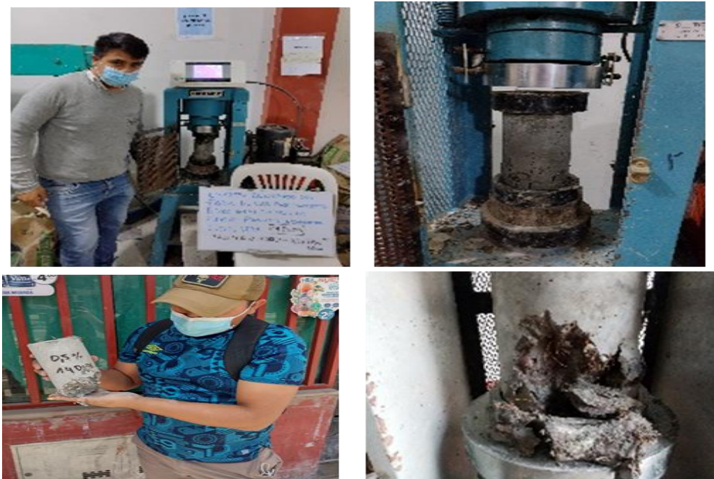
Figura 71. Ensayo de resistencia a compresión de muestras cilíndricas
