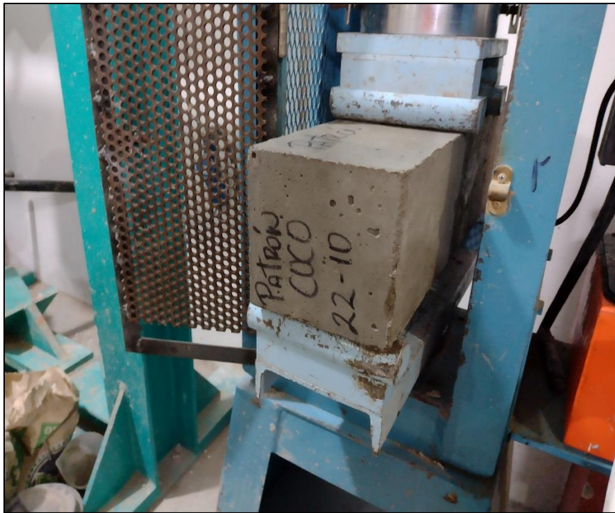
Figura 18. Máquina de ensayo a flexión
