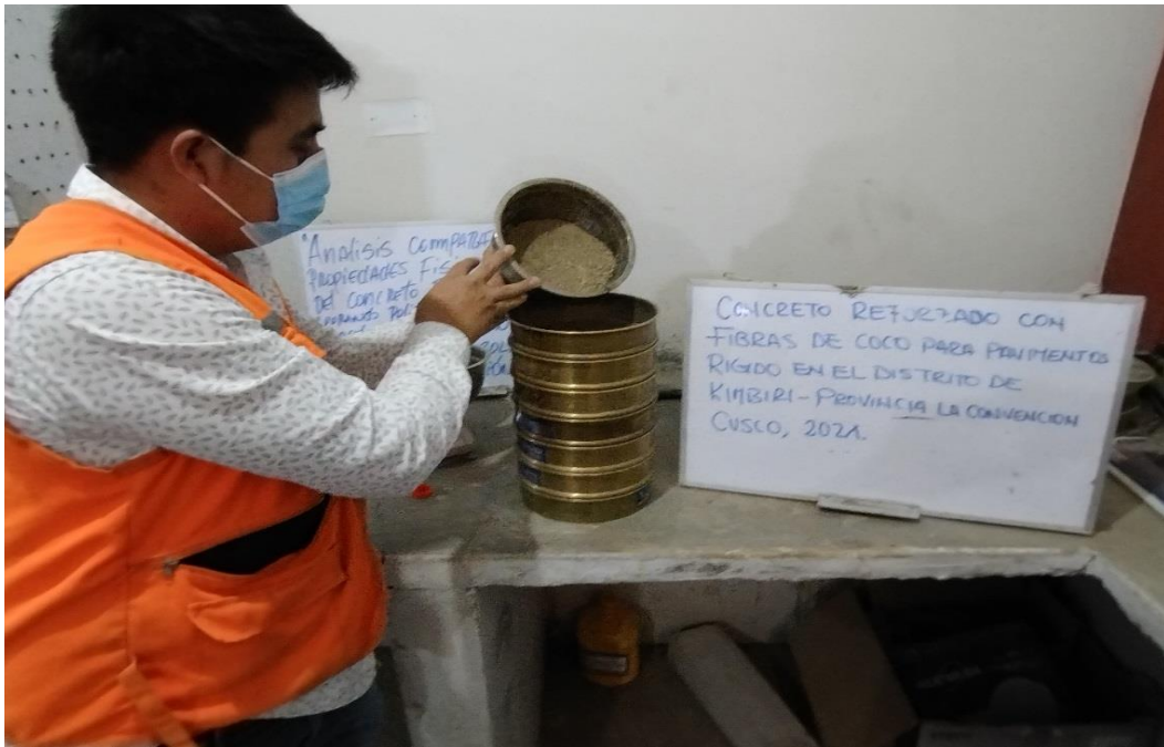
Figura 58. Tamizado de los agregado finos
