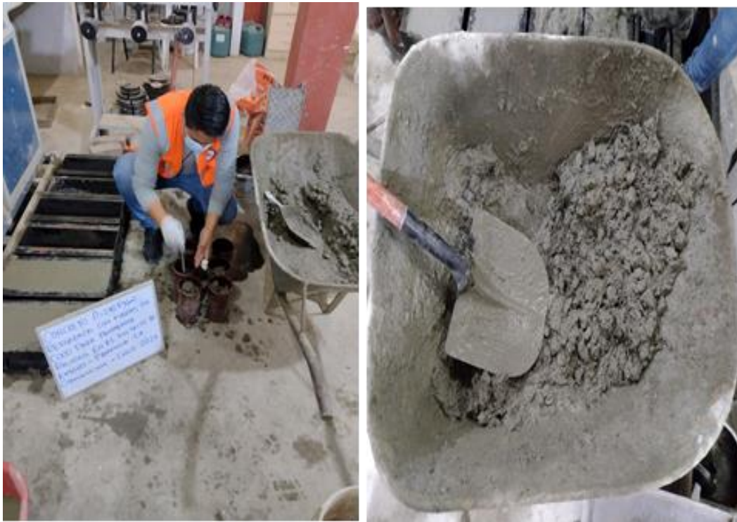
Figura 67. Muestreo de probetas cilíndricas
