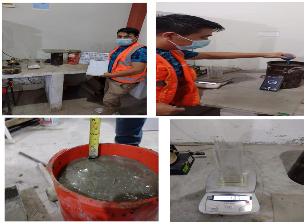
Figura 78. Control de tiempo para el retiro del agua exudada del concreto y luego ser pesado en una balanza
