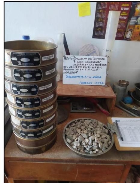
Nota: La figura representativa de la muestra de agregado grueso tomada por parte del autor para su análisis en el laboratorio de mecánica de suelos. Fuente: elaboración propia.
