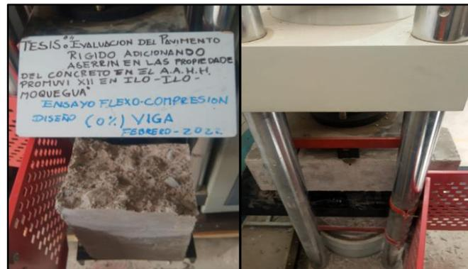
Nota: La figura representativa del diseño del concreto para ensayo flexo – tracción, con una resistencia a la compresión de  $210\text{kg/cm}^2 + 0\%$  de aserrín. Fuente: elaboración propia
