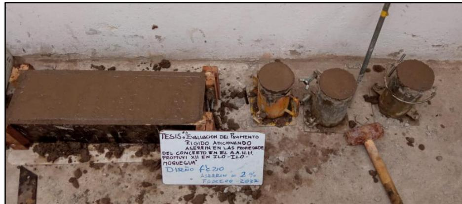
Nota: La figura representativa del diseño del concreto para ensayo de flexion, con una resistencia a la compresión de  $210\text{kg/cm}^2 + 2\%$  de aserrín.
