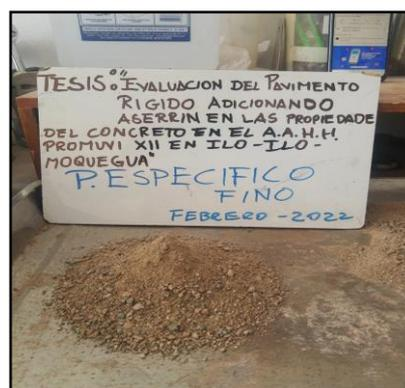
Nota: La figura representativa de la muestra de agregado fino tomada por parte del autor para su análisis en el laboratorio de mecánica de suelos. Fuente: elaboración propia
