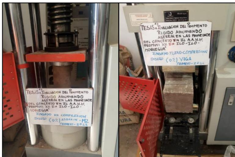
Nota: La figura representativa del diseño del concreto con una resistencia a la compresión de 210kg/cm<sup>2</sup> + 0% de aserrín. Fuente: elaboración propia
