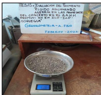
**Figura 10** Peso específico del Agregado Fino
