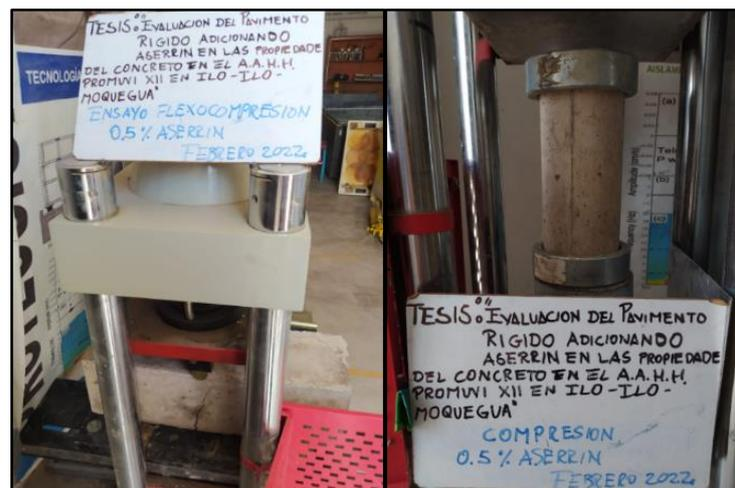
Nota: La figura representativa del diseño del concreto con una resistencia a la compresión de 210kg/cm<sup>2</sup> + 0.5% de aserrín. Fuente: elaboración propia
