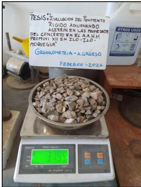
**Figura 8 Granulometría del Agregado Grueso**
