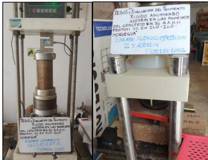
Nota: La figura representativa del diseño del concreto con una resistencia a la compresión de 210kg/cm<sup>2</sup> + 2% de aserrín. Fuente: elaboración propia
