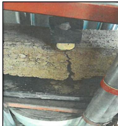
Nota: La figura representativa del diseño del concreto para ensayo flexo – tracción, con una resistencia a la compresión de  $210 \text{ kg/cm}^2 + 4\%$  de aserrín. Fuente: elaboración propia
