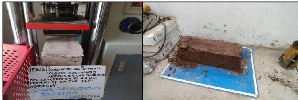
Nota: La figura representativa del diseño del concreto para ensayo flexo – tracción, con una resistencia a la compresión de 210kg/cm<sup>2</sup> + 0.5% de aserrín. Fuente: elaboración propia
