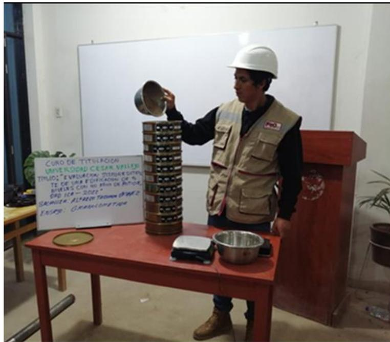
Figura N°14. Ensayo de Granulometría por tamizado
