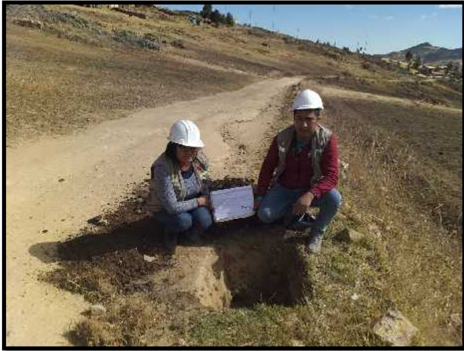
Calicata N.º 5 Estudio de Mecánica de Suelos
