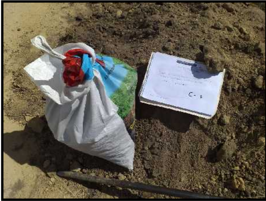
Muestra 30kg de la Calicata N.º 1 para el Estudio de Mecánica de Suelos.
