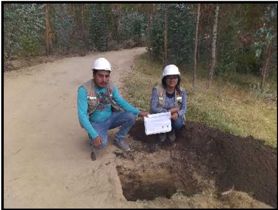
Calicata N.º 4 Estudio de Mecánica de Suelos
