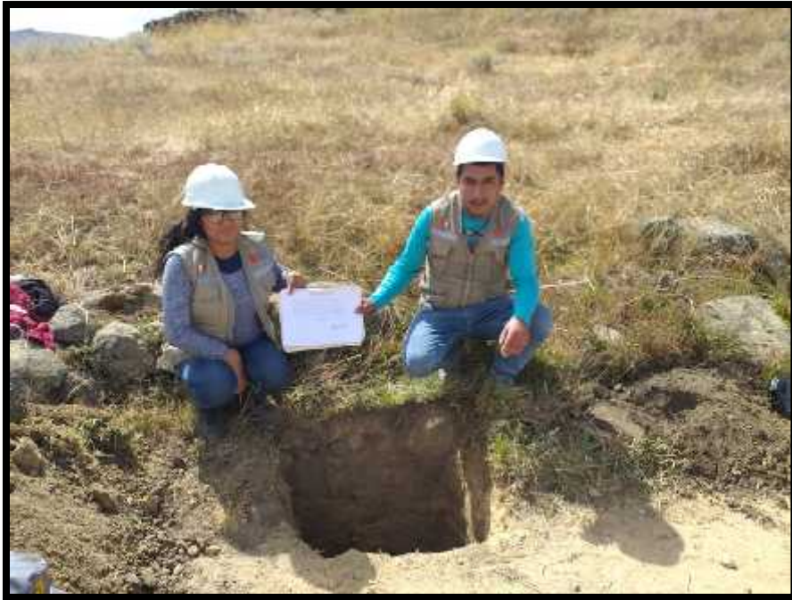
Calicata N.º 1 Estudio de Mecánica de Suelos
