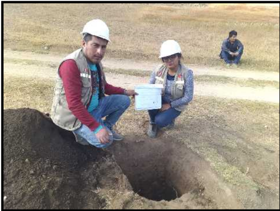
Calicata N.º 8 Estudio de Mecánica de Suelos
