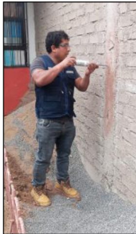
Aplicación de esclerómetro a Columna - 02
