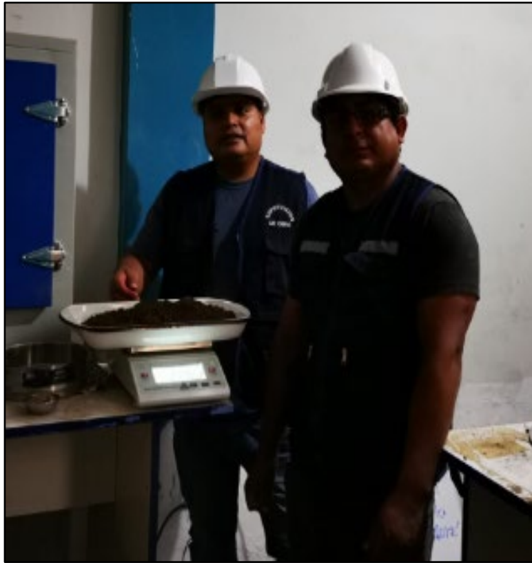
Foto 09: Pesado de la muestra a 2500g para molde de método A
