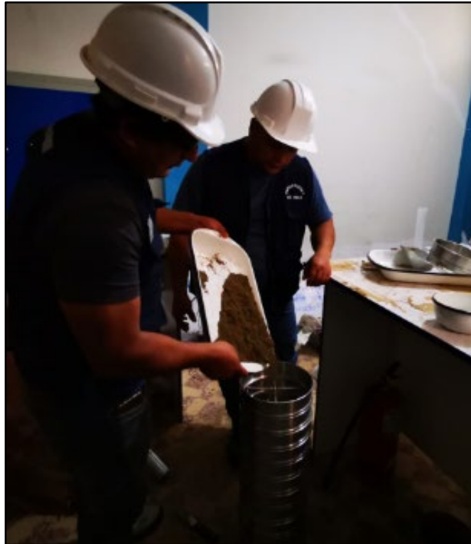
Foto 07: Tamizado por del material seco
