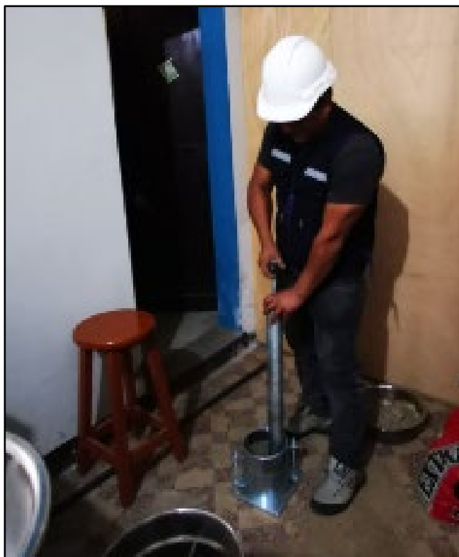
Foto 11: Compactación a los 25 golpes
