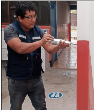
Aplicación de esclerómetro a Columna - 05
