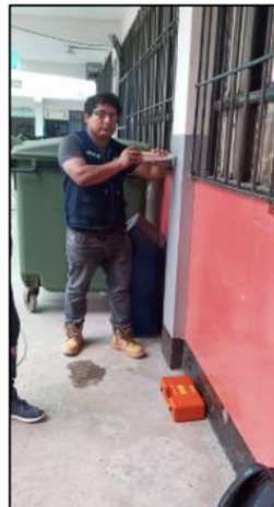
Aplicación de esclerómetro a Columna - 04
