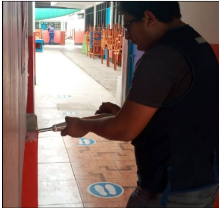
Foto 13: Aplicación de esclerómetro
