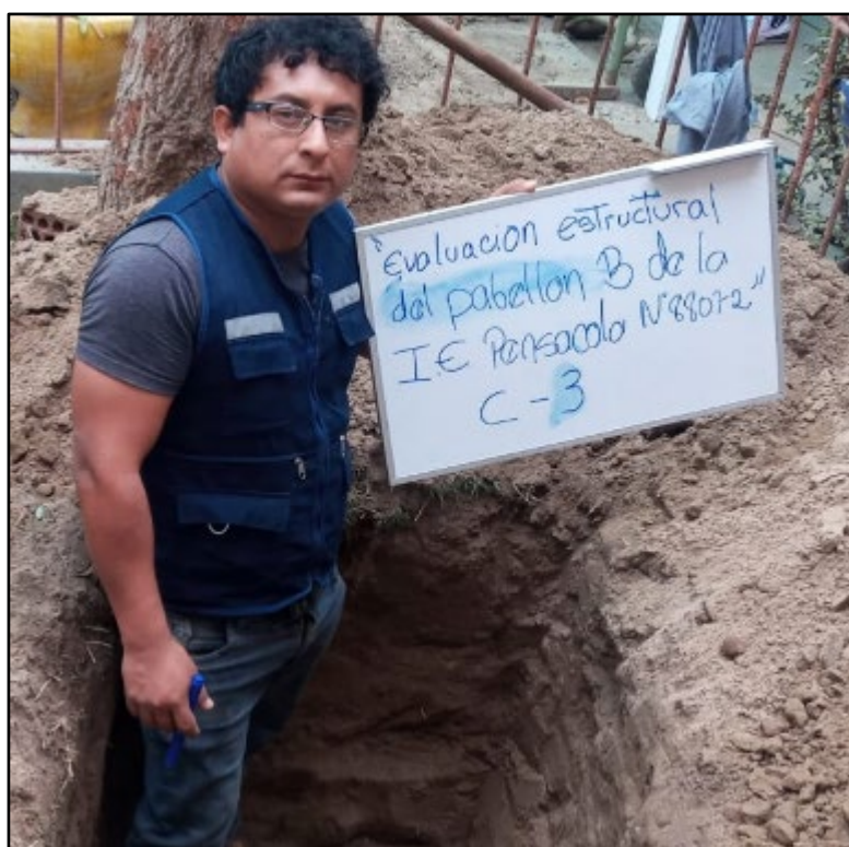
Foto 04: Excavación de calicata 03
