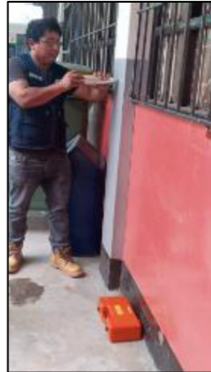
Aplicación de esclerómetro a Columna - 08
