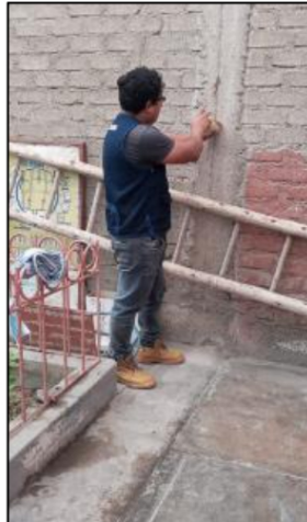
Aplicación de esclerómetro a Columna - 03
