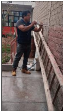
Aplicación de esclerómetro a Columna - 01
