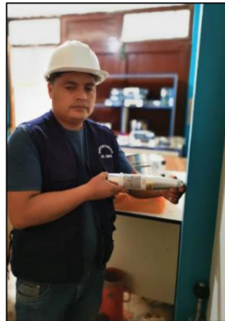
Aplicación de esclerómetro a Columna - 07
