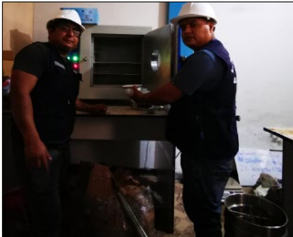
Foto 06: Secado de la muestra lavada retenida por el tamiz # 200
