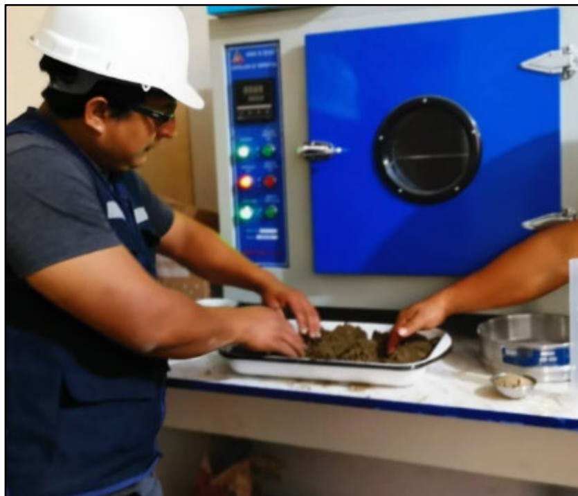
Foto 10: cuarteo de la muestra en 5 partes
