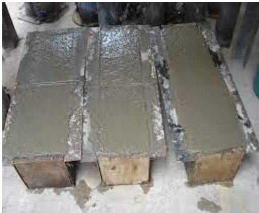
Ensayo de viga a flexión
