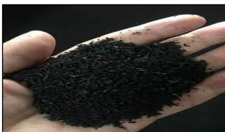
La calidad de las partículas de caucho reciclado es muy importante para la trituración mecánica con el fin de obtener partículas de caucho de las mismas dimensiones en el proceso de fabricación sin residuos, como alambres y otras partes dañinas. (García, 2016).
