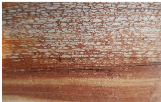
Figure 1.7 : Les alvéoles blanchâtres causées par la dégradation de la lignine (Boulet, 2003)
