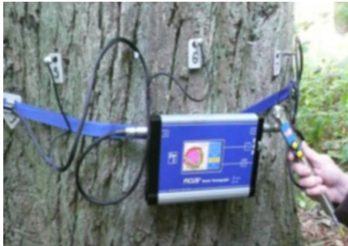
Figure 2.7 : Installation du tomographe acoustique sur le tronc de l'arbre
