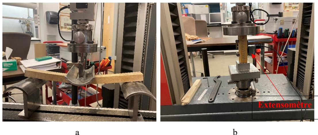
Figure 2.5 : a) Banc d'essai pour la mesure du MOE en flexion ; b) Banc d'essai pour la mesure de la résistance en compression parallèle (ASTM-D143)
