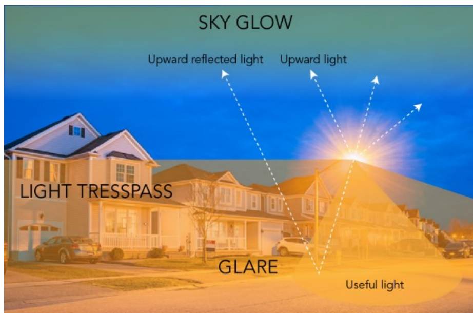
Obrázek 1: Vznik a formy světelného znečištění. Převzato z Tarta (2020).
