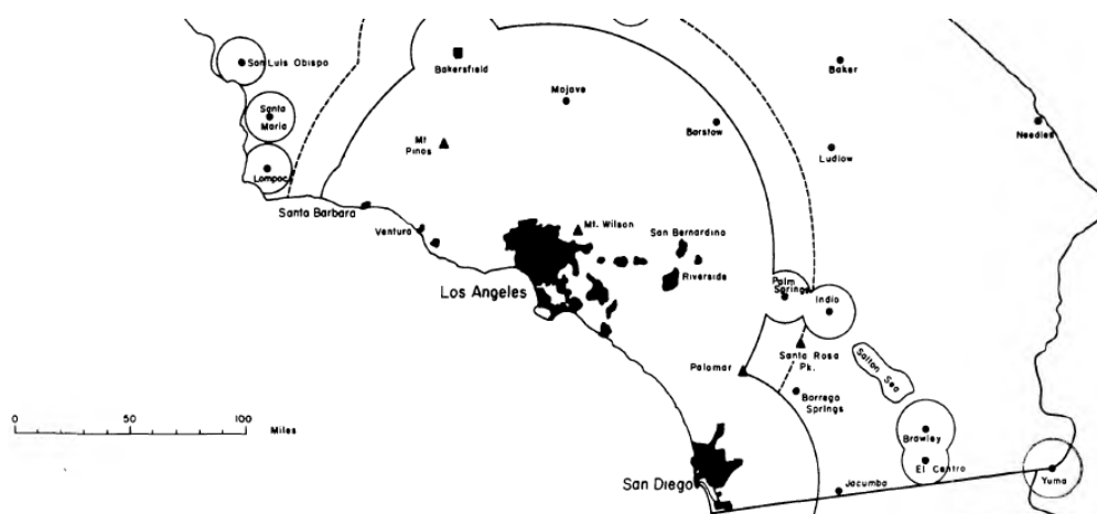
Obrázek 55: Výřez z mapy světelného znečištění v jižní části Kalifornie. Plnou čarou jsou ohraničeny oblasti, kde v roce 1970 zvýšený jas v zenitu o 0,1 mag a více a 0,2 mag a více ve výšce 45^\circ nad zdrojem světla. Přerušovanou čarou jsou ohraničeny předpokládané oblasti rozšíření světelného znečištění v roce 1985. Převzato z Walkera (1970).
