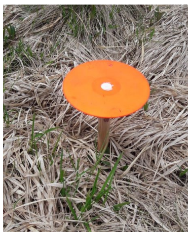
Obr. 6 Kontrolní bod v terénu pro hodnocení polohové přesnosti mozaiky. Autor: Lucie Červená
