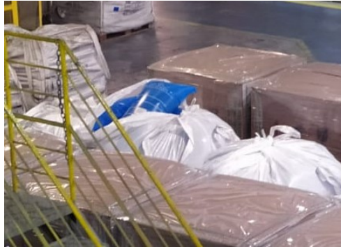
Figura 6 - Embalagem da Massa de socar estufada pela liberação de gás hidrogênio
