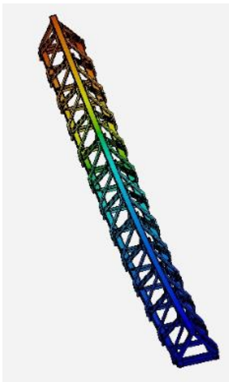
Figura 6.2 - Modo de vibrar para a frequência natural 2 (Fonte: Autor)
