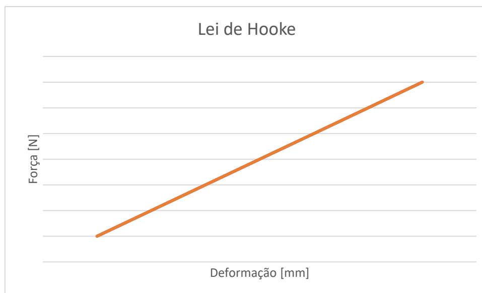
Gráfico 3.1 - Gráfico de Força por Deformação em mola (Fonte: Autor)
