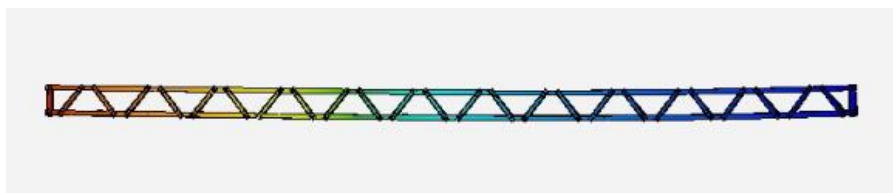
Figura 6.1 - Modo de vibrar para frequência natural 1 (Fonte: Autor)
