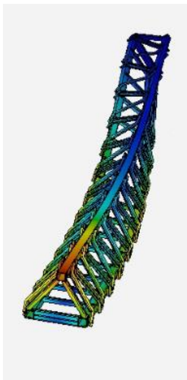
Figura 6.3 - Modo de vibrar para a frequência natural 3 (Fonte: Autor)
