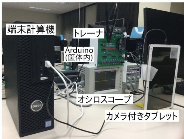
図 6 システム外観 Fig. 6 Final system appearance.
