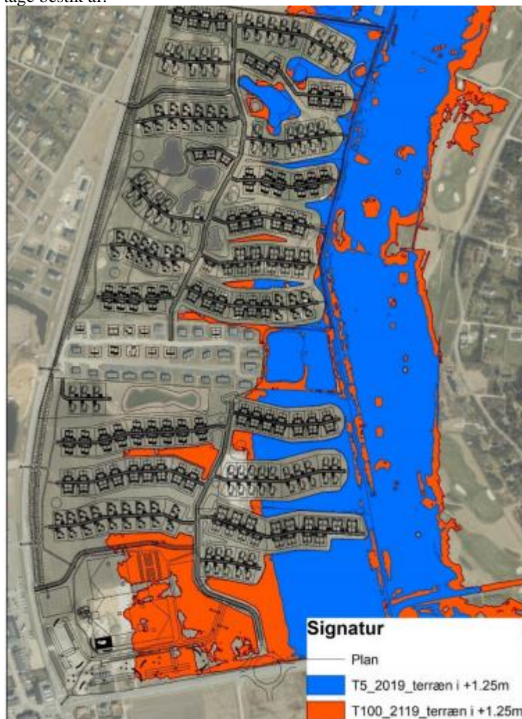
Figur 2-5 Visning af mulige udbredelser samt kote for en nuværende 24 timers regn med gentagelsesperiode på 5 år samt en fremtidig 24 timers regn med gentagelsesperiode på 100 år beregnet på de fremtidige terrænforhold hvor veje og områder med bebyggelser er hævet til kote +1,25m. Der er forudsat at pumpens fulde kapacitet ( 1\text{m}^3/\text{s} ) er til rådighed og der er således ikke indregnet tørvejrflow samt fremskrivning af tørvejrflow over tid.
