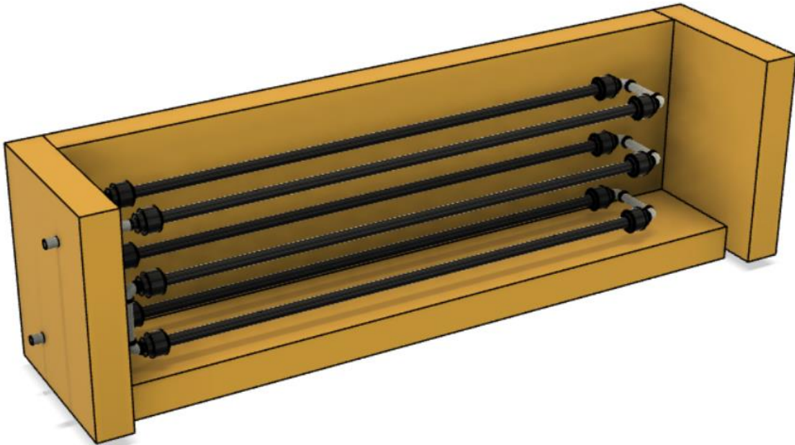
Abbildung 5: Seitenansicht des Tanks ohne Sand und Seiten- und Deckendämmung.
