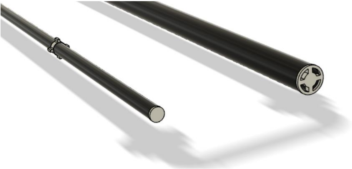
Abbildung 6: 16 mm Rohr mit Endkappe und Distanzstück (Links) und 32 mm Rohr mit Anschlag (Rechts).
