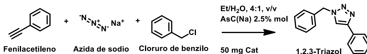
Figura 3. Esquema de reacción de la evaluación catalítica del MCM-41 Cu
