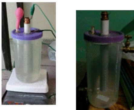
**Figura 2.** Reactor experimental para los tratamientos electroquímicos.
