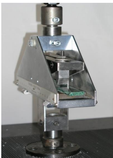
Figura 2. Fotografía del dispositivo completo y ya montado en la máquina United. La probeta de vidrio está en la parte media y se puede observar uno de los apoyos superiores apuntando hacia abajo
