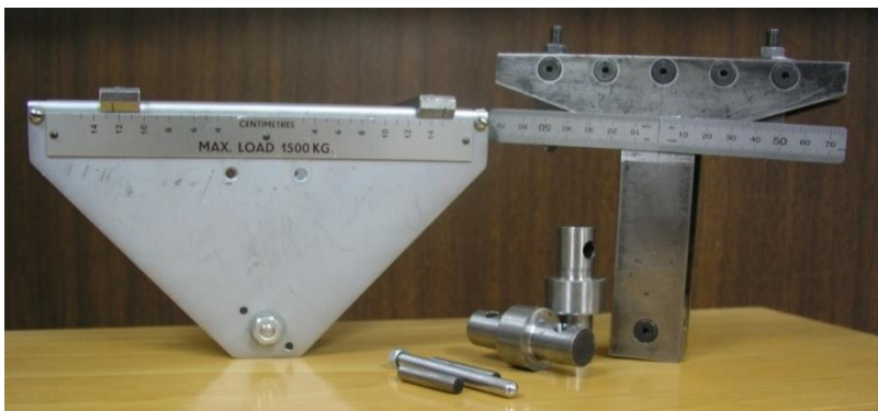
Figura 1. Fotografía del dispositivo para flexión en cuatro puntos
