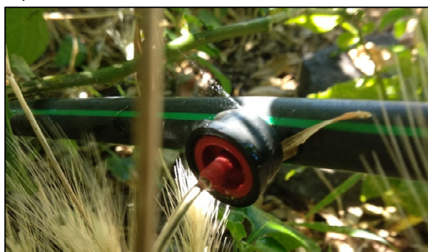
Figura 18- Emissor 1 no início da linha 11, que apresenta um caudal em jato e fuga de água
