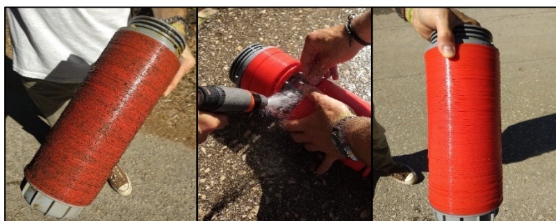
Figura 14- Filtro de discos antes, durante e após a limpeza
