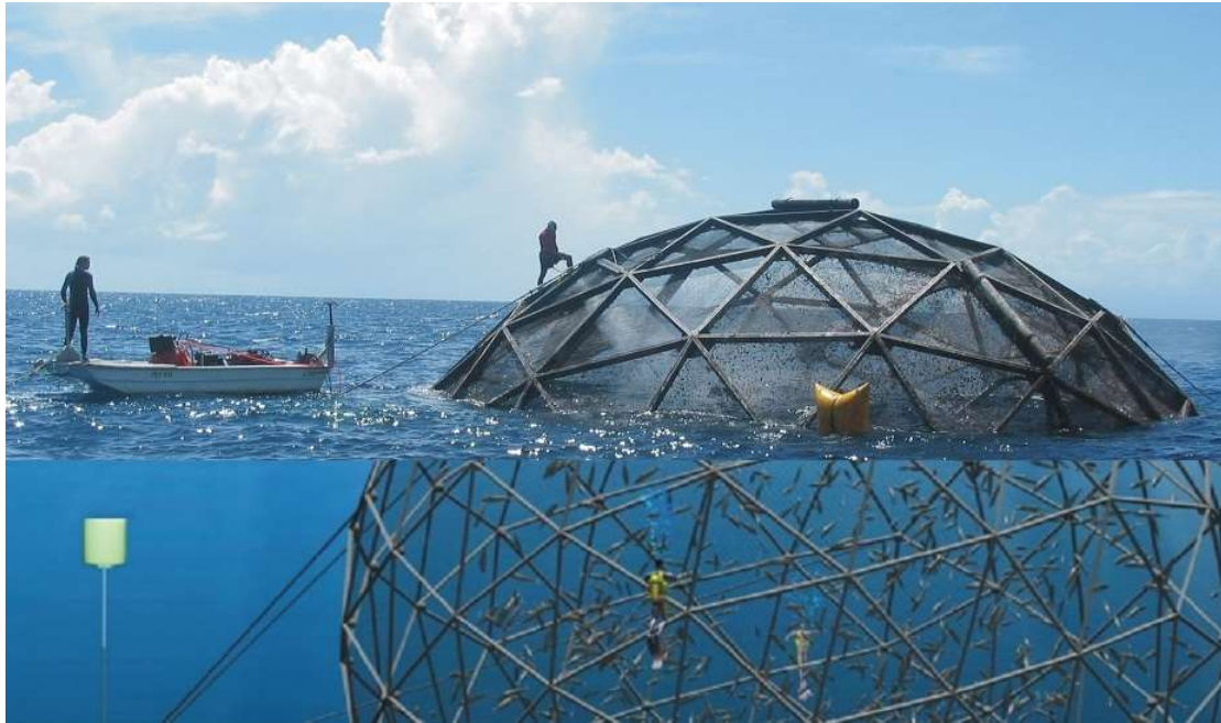
Εικόνα 12: Ιχθυοκλωβός τύπου Aquapod (Πηγή: https://atlasofthefuture.org/project/aquapod-fish-farm/ )
