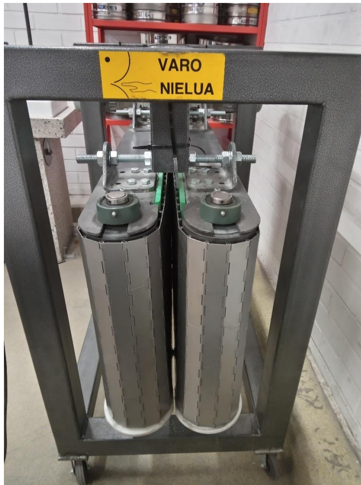
Kuva 1b. Demo-kokoluokan Hugger-murskain edestä nielun puolelta kuvattuna. Kuvassa näkyy telojen välisen raon kapeneminen eteen- ja alaspäin mentäessä. Telojen välinen rako on säädettävissä. (Kuva: Samuel Hartikainen).
