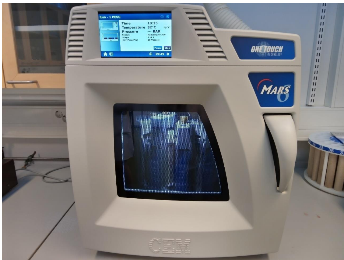
Kuva 6. Tässä opinnäytetyössä ja tutkimuksessa käytetty mikroaaltouuni MARS 6, joka sijaitsee Itä-Suomen yliopiston farmasian laitoksella Kuopion kampuksella. (Kuva: Samuel Hartikainen)
