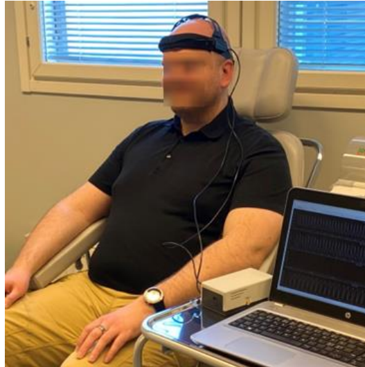
Kuva 18. Oulun yliopistossa kehitetty pienikokoinen NIRS-laite.
