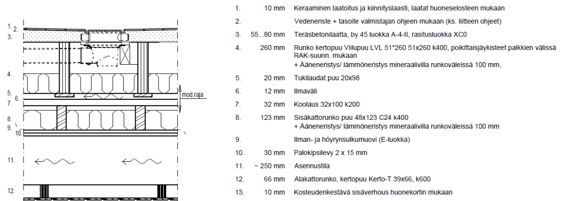
Kuva 19. Välipohja märkätilan kohdalla.
