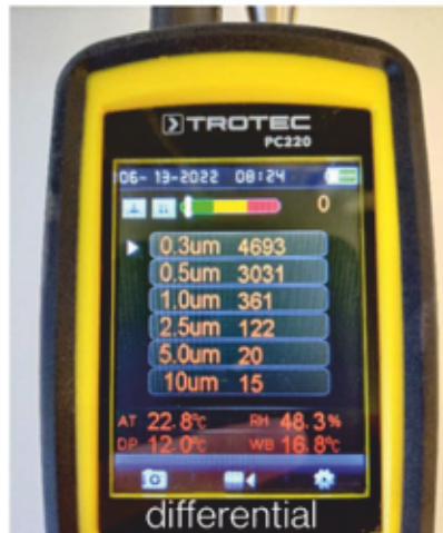
Kuva 5. Esimerkki PC220-mittarin differentiaalisen mittaustoiminnon lukemien tulkitsemisesta.
