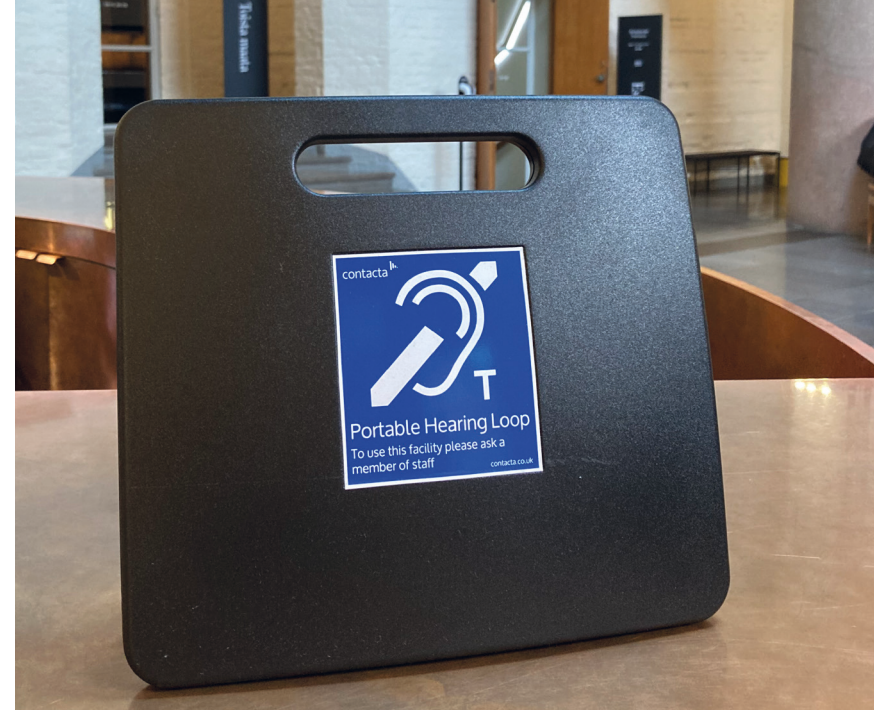
Kuva 36. Kannettava palvelupistesilmukkalaite nostettuna esille tarkasteltavaksi Keskushallin lipunmyynnissä. Nykyisen standardin mukainen symboli on laitteessa kiinni tarrana. Valokuva Elina Turpeinen 2022.
