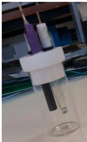
Figura 11. Célula de três eletrodos: eletrodo de trabalho (centro), eletrodo de referência (direita) e eletrodo secundário (esquerda)
