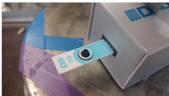
Figura 12. Célula de três eletrodos SPCE ligada à interface *DropSens* (*DRP-DSC*)
