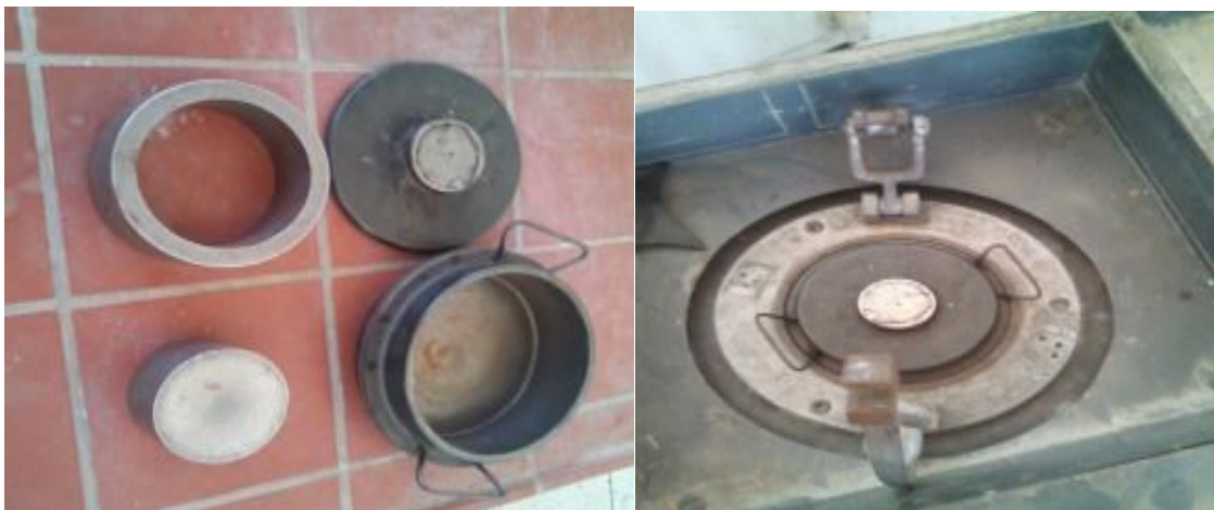
Figure 3.4 : Constituants du broyeur à disques.
