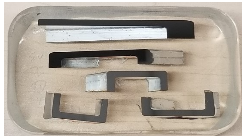
figure 3.16, Exemple d'échantillons pour la prise de mesure de microdureté Vickers
