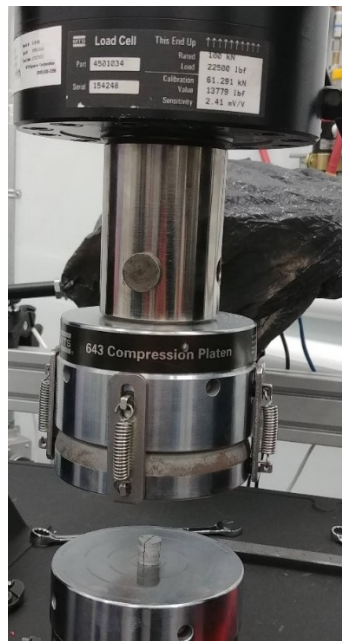
figure 3.10, Montage de l'essai de compression de disque
