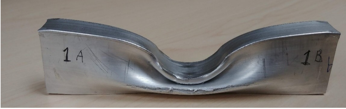
figure 3.28, Fissuration du tube de l'essai #2 vue de côté
