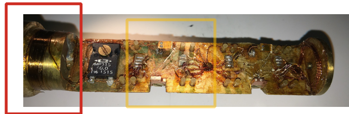
FIGURE 3.4 Schéma du montage expérimental de la sonde VTI utilisée dans cette thèse. (a) Vue de côté. L'échantillon, collé sur le bloc de cuivre, est inséré sur la sonde de façon à ce que le champ magnétique H soit perpendiculaire au courant de chaleur J . (b) Vue de haut. La source de chaleur est reliée à l'échantillon par un fil d'argent. Un thermocouple différentiel est utilisé pour obtenir \Delta T_y . Un second thermocouple différentiel est utilisé pour obtenir \Delta T_x . Un thermocouple absolu est connecté à T^- . (c) Photo de la sonde. Le schéma de montage présenté en (a) et (b) est encadré en jaune. La source de chaleur principale (fil de manganèse) de la sonde est enroulée autour de la sonde (encadré rouge).
