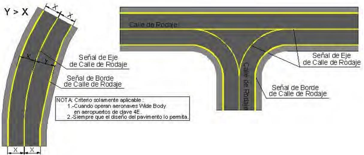
Figura 14.4.5. Detalle de la señal de eje de calle de rodaje en curva.
