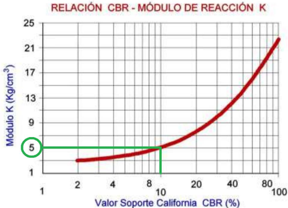
Figura 6.28. Relación CBR y Módulo de reacción K.
