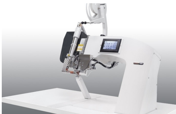
Slika 20: Stroj za termično/toplotno spajanje tekstilij [35]
