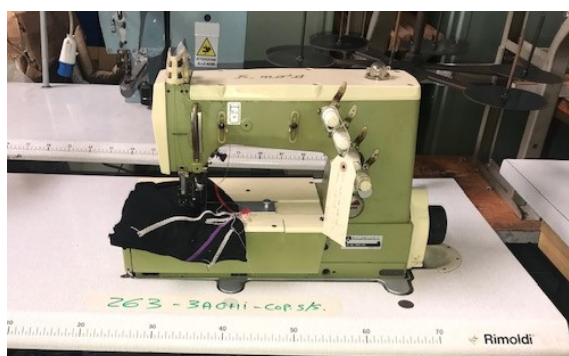
Slika 17: Specialni šivalni stroj za izdelavo kritnih šivov s tipoma vbodov 602 in 605 [32]
