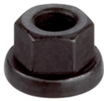
Slika 6.43: Šestrobna matica s podložko, DIN 6331, M12, kakovost 10 [40]
