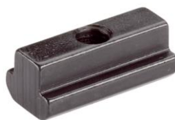
Slika 6.42: Matica za T-utor, dolga izvedba, M12 x 14, kakovost 10 [39]
