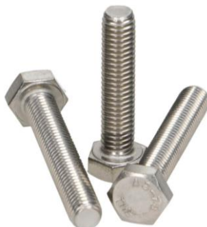
Slika 6.45: Inox vijak s šestrobo glavo, M5, DIN 933, nerjavni A2 [42]
