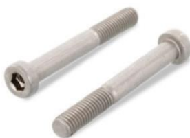
Slika 6.44: Vijak z nizko cilindrično glavo, M8, DIN 6912, nerjavni A2 [41]
