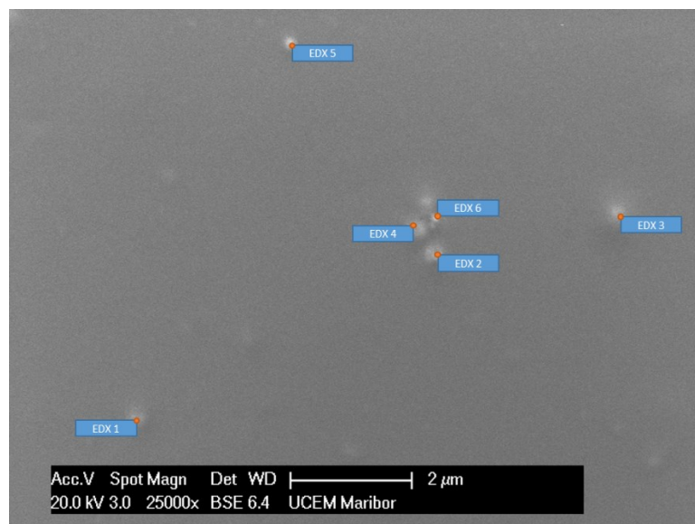
Slika 4.5: SEM posnetek nanosa nanokompozita z označenimi mesti EDX.
