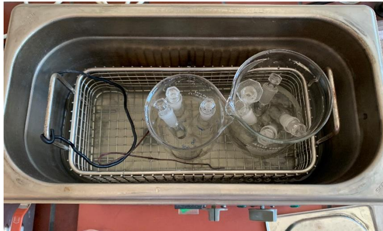
Slika 4-7: Raztapljanje pripravljenih vzorcev v ultrazvočni kopeli.
