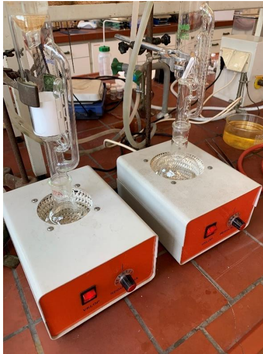
Slika 4-1: Ekstrakcija polietilenskega filma z 2-propanolom (levo) in diklorometanom (desno).
