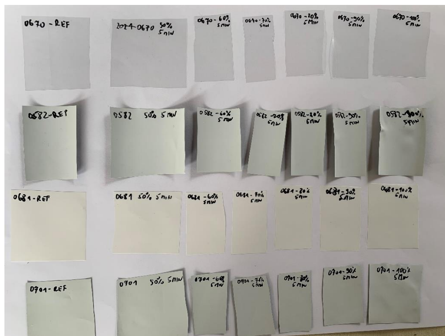
Slika 5-10: Testiranje vzorcev 6, 7, 8 in 9 v UV komori.
