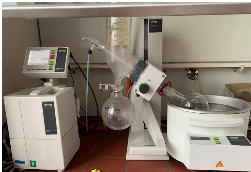
Slika 3-3: Laboratorijski rotacijski vakuumski uparjalnik.
