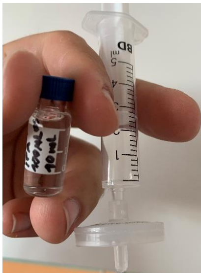
Slika 4-8: Filtriranje raztopine s PTFE filtrom.
