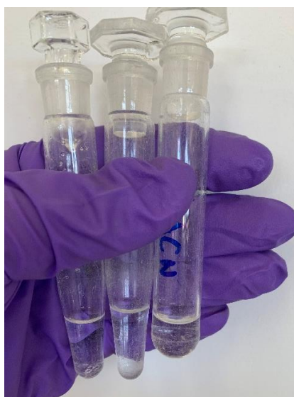
Slika 4-6: Test topnosti vzorca trdnih delcev v topilih: metanol (levo), 2-propanol (na sredini) in acetonitril (desno).
