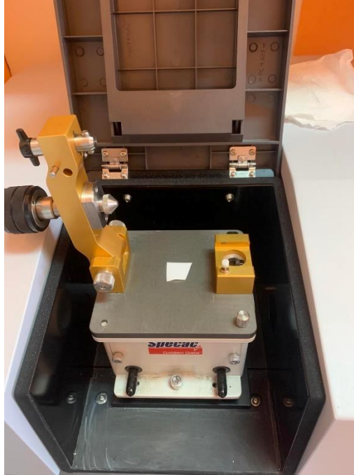
Slika 4-13: Vzorec filma pred analizo FTIR.
