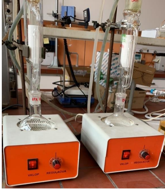
Slika 4-2: Ekstrakcija vzorca 10 z 2-propanolom (levo) in diklorometanom (desno).
