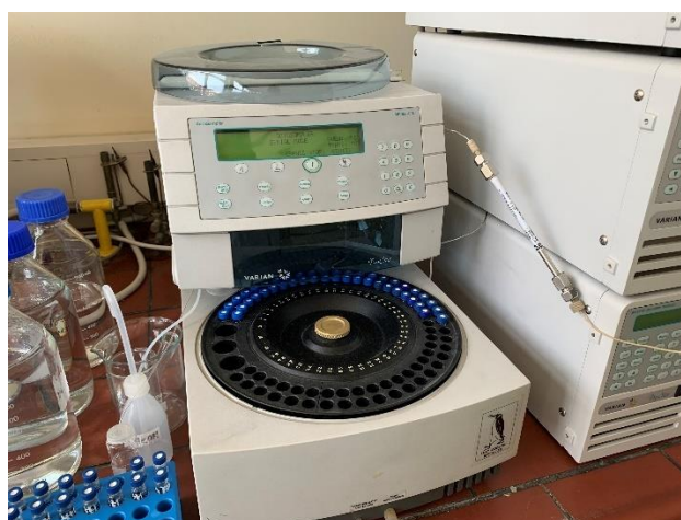
Slika 4-11: Vzorca v avtomatskem vzorčevalniku med izvajanjem HPLC analiz.
