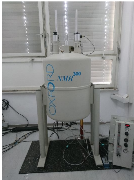
Slika 3-7: Naprava za izvajanje nuklearne magnetne resonance (NMR).
