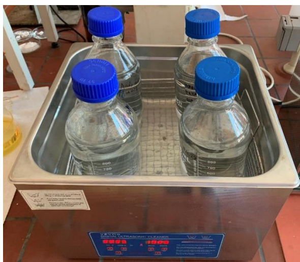
Slika 4-10: Razplinjenje mobilne faze B v ultrazvočni kopeli.
