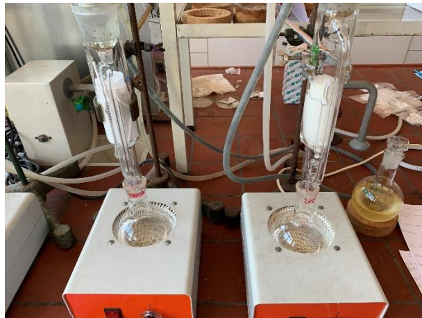
Slika 4-3: Ekstrakcija vzorca 1 in vzorca 10 za analizo z NMR.
