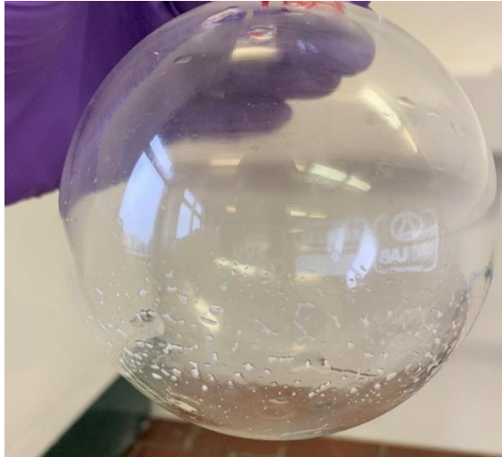
Slika 4-4: Vzorec v destilacijski bučki po uparjanju z rotacijskim uparjalnikom.
