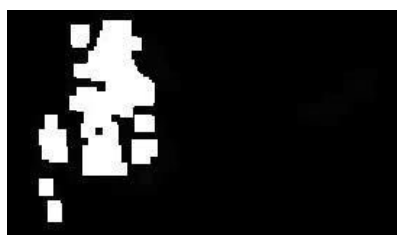
Fig. 11 Imagen resultado de 2 dilataciones, 6 erosiones y 4 dilataciones.
