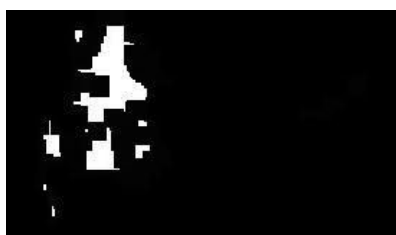
Fig. 10 Imagen resultado de 2 dilataciones y 6 erosiones.
