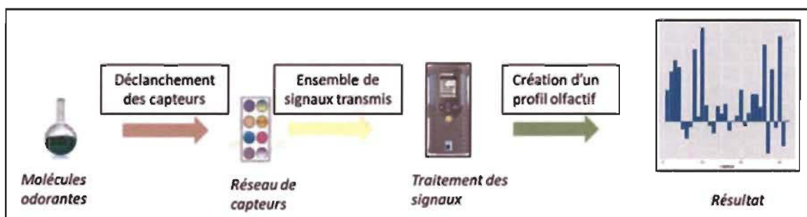
Figure 1.3 Schéma simplifié de la création d'un profil olfactif en 32 dimensions par le nez électronique Cyranose 320.
