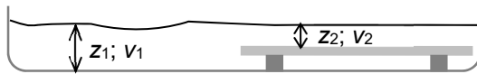
Figura 3: la velocitat de propagació de les ones d'aigua depèn de la profunditat z . Si z_1 > z_2 , llavors v_1 > v_2 .
