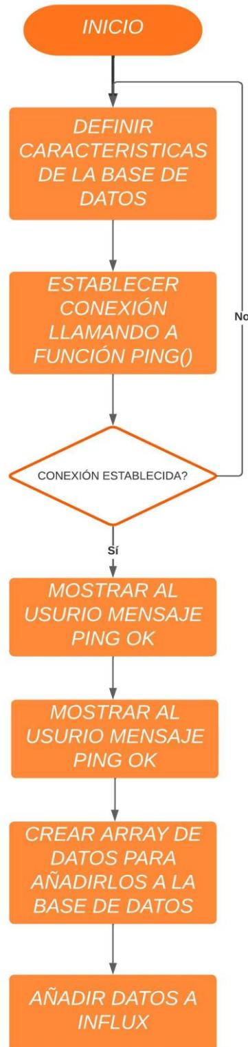
Ilustración 35: Diagrama de flujo de la conexión con Influx a través de Matlab
