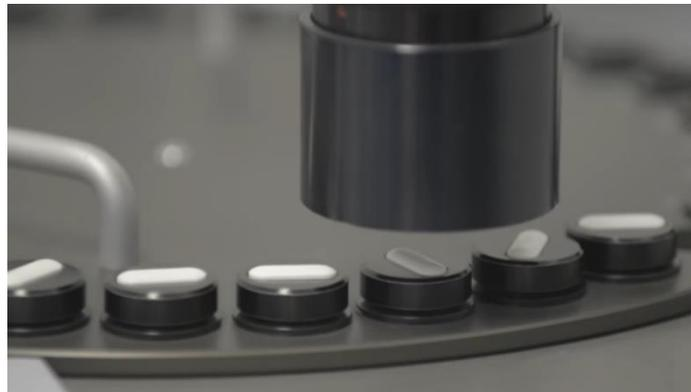
*Ilustración 2: Uso de visión artificial para control de calidad en comprimidos*
