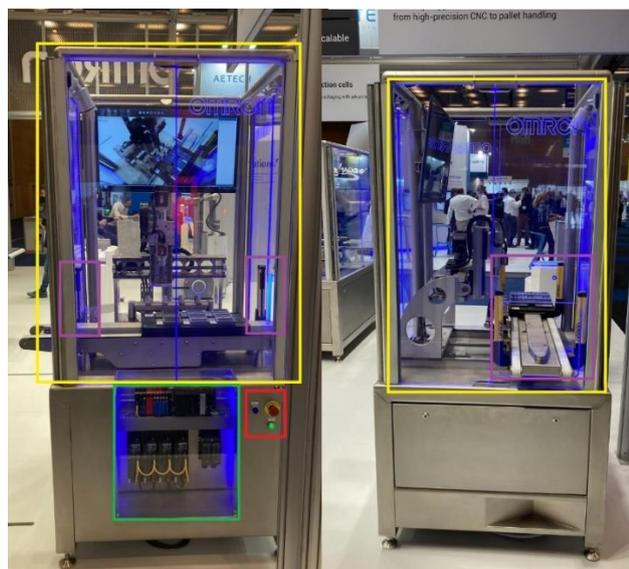
Figura 18 Demostración de un sistema robótico. Incluye resguardo(amarillo), cortinas fotoeléctricas(lila), unidad de control(verde) y botón de paro de emergencia, rearme e inicio(rojo). (Fuente propia durante el Advanced Factories 2022, exposición de OMRON)
