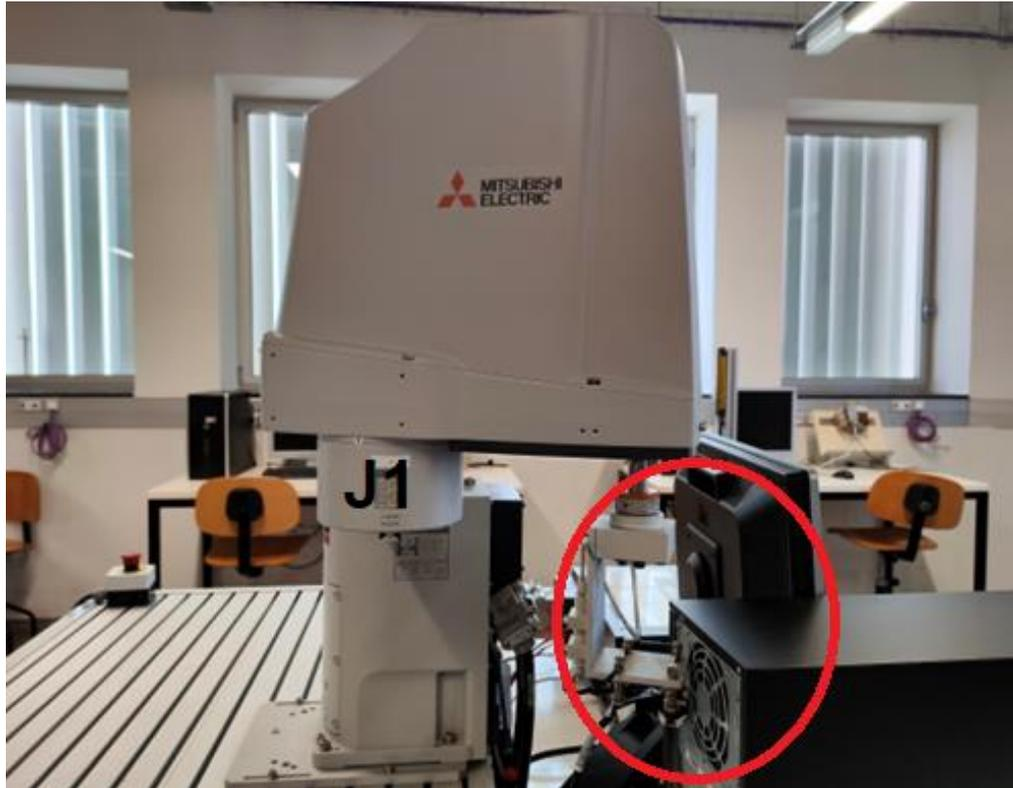
Figura 14 Posible colisión entre el SCARA y el ordenador si solo se limita J1 hasta  $-90^\circ$ . (Fuente propia)
