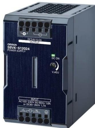
Figura 39 Fuente de alimentación(S8VK-S12024) 120W/24V/5ª carril DIN Push-in+. (Fuente OMRON [25])
