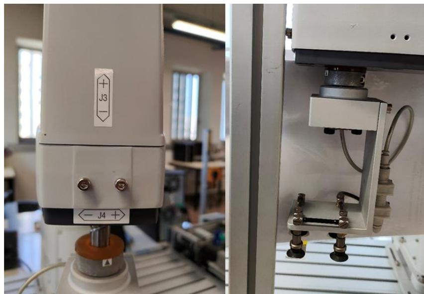
Figura 11 Elemento terminal (derecha) y grados de libertad de este J3 y J4 (izquierda). (Fuente propia)
