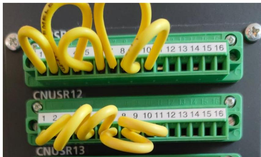
Figura 21 Conectores CNUSR11 y CNUSR12 del controlador CR750-D, con los cortocircuitos necesarios para el funcionamiento del controlador sin elementos de seguridad externos. (Fuente propia)
