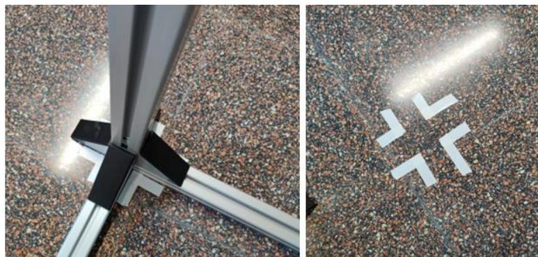
Figura 51 Indicador de posición de las cortinas fotoeléctricas. (Fuente propia)
