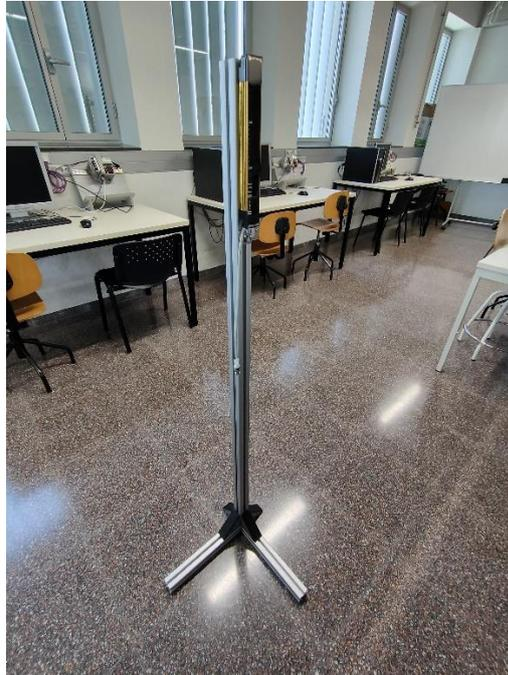
Figura 50 Soportes empleados para posicionar las cortinas fotoeléctricas de forma vertical. (Fuente propia)
