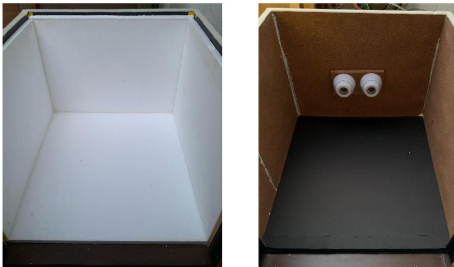
*Ilustración 4.7 – Cámara caliente (derecha) y Cámara ambiente (izquierda) (Elaboración propia)*
