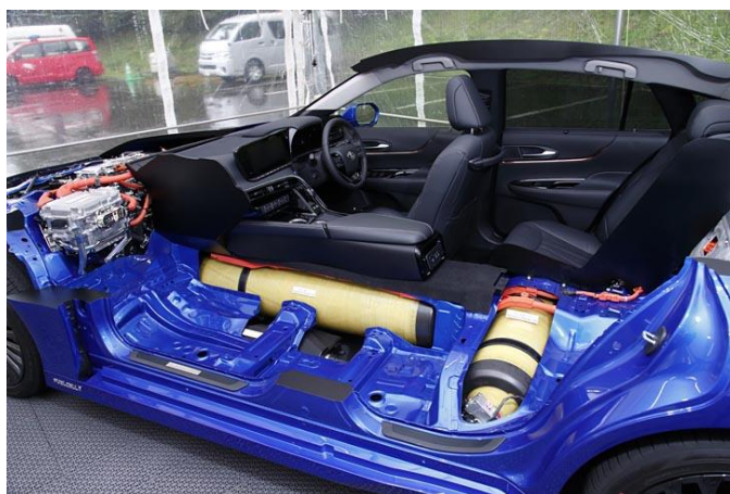
Figura 19 - Disposició d'elements del Toyota Mirai 2020 (23)
