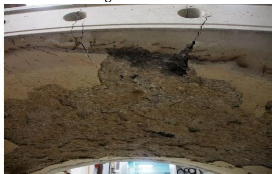
Figura 7. Dovela de hormigón reforzado con fibras poliolefina sometida a fuego
