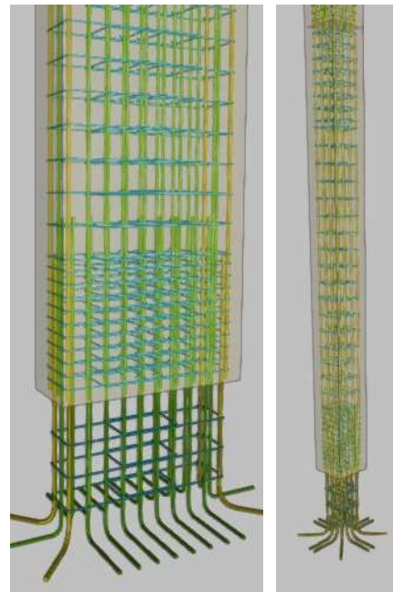
Imagen nº10 y 11 Detalle de armado de pilares
